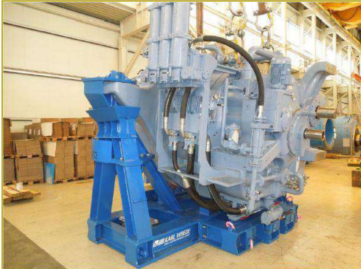
Offshore-Transportgestell Getriebe 6 MW
