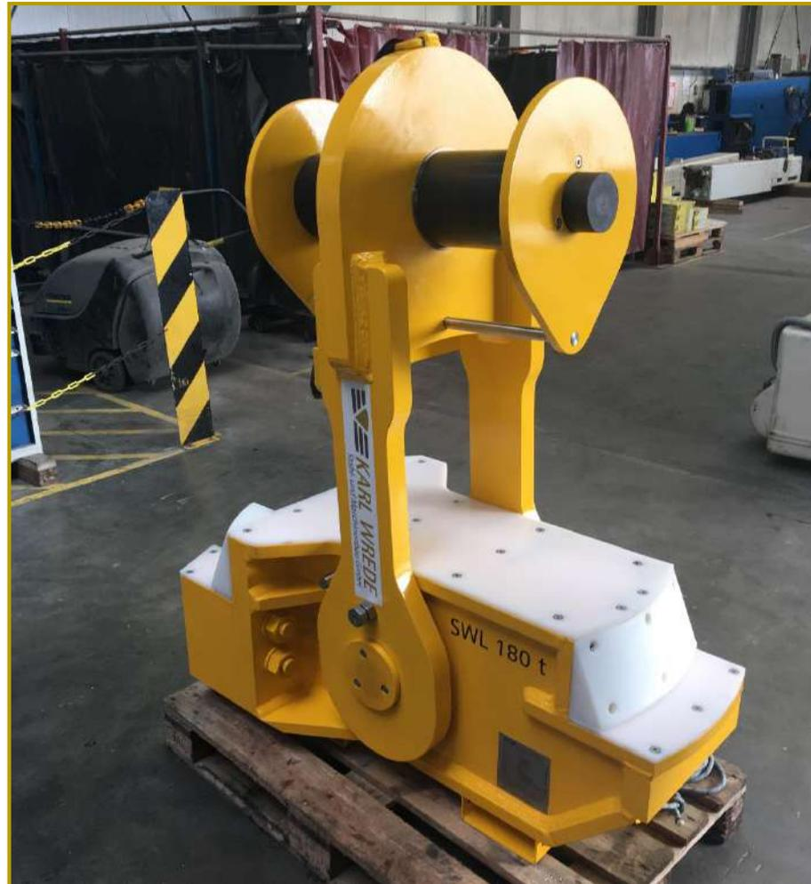
Lastaufnahmemittel Rotorstern SWL 180 t – 6 MW
