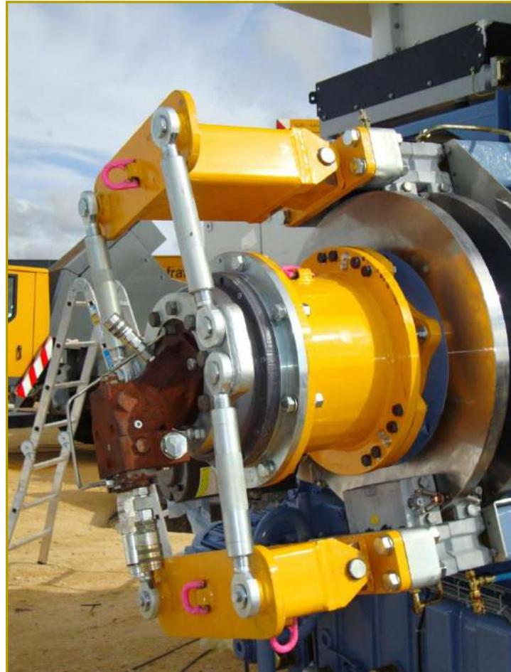
Hydraulisches Drehantriebssystem Triebstrang 3 MW (Einzelblattmontage)
