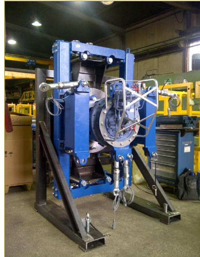
Hydraulisches Drehantriebssystem Triebstrang 6 MW offshore (Einzelblattmontage): Testvorrichtung
