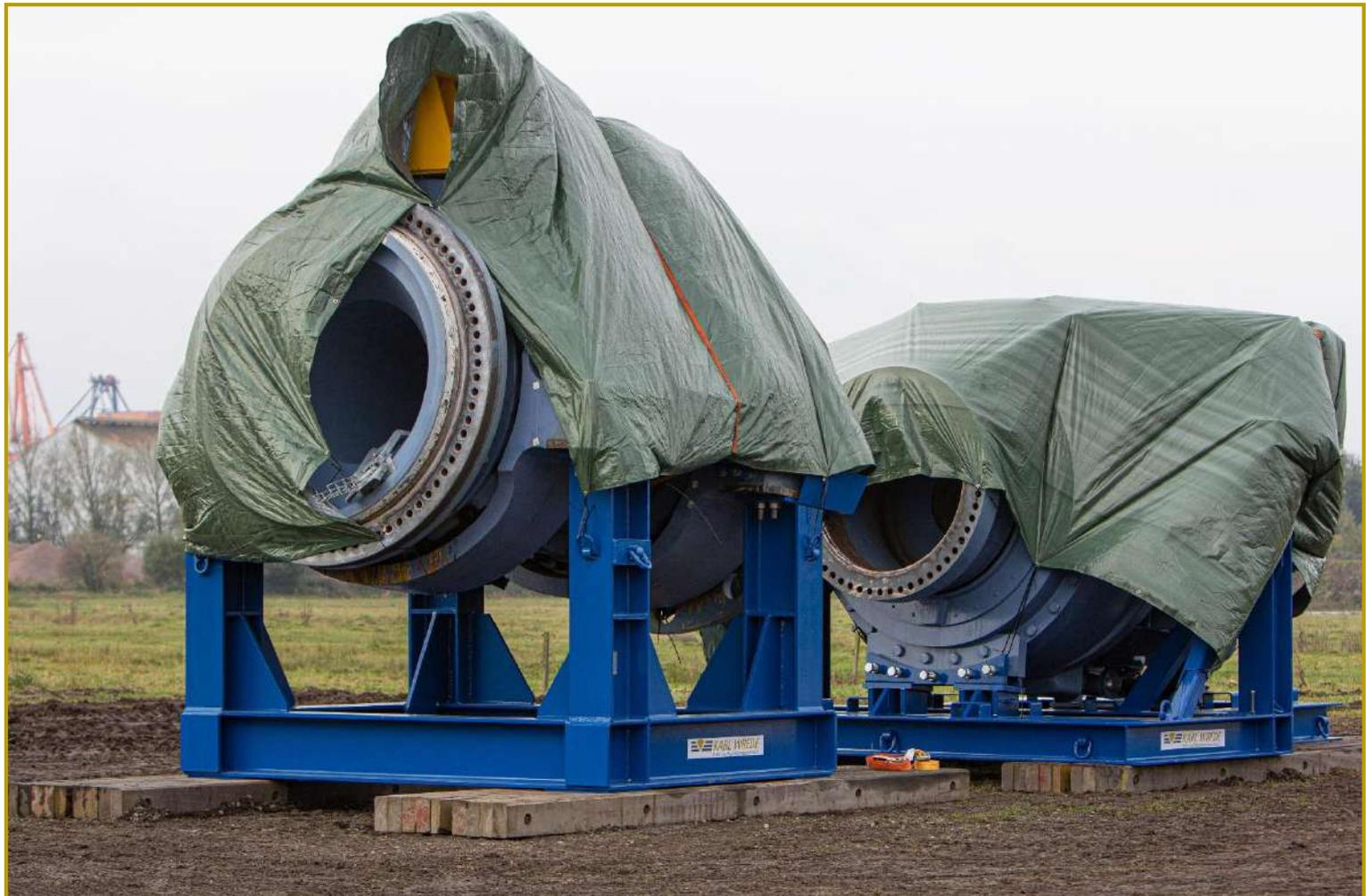
Offshore-Transportgestell Rotortwellenbaugruppe und Getriebe 5 MW
