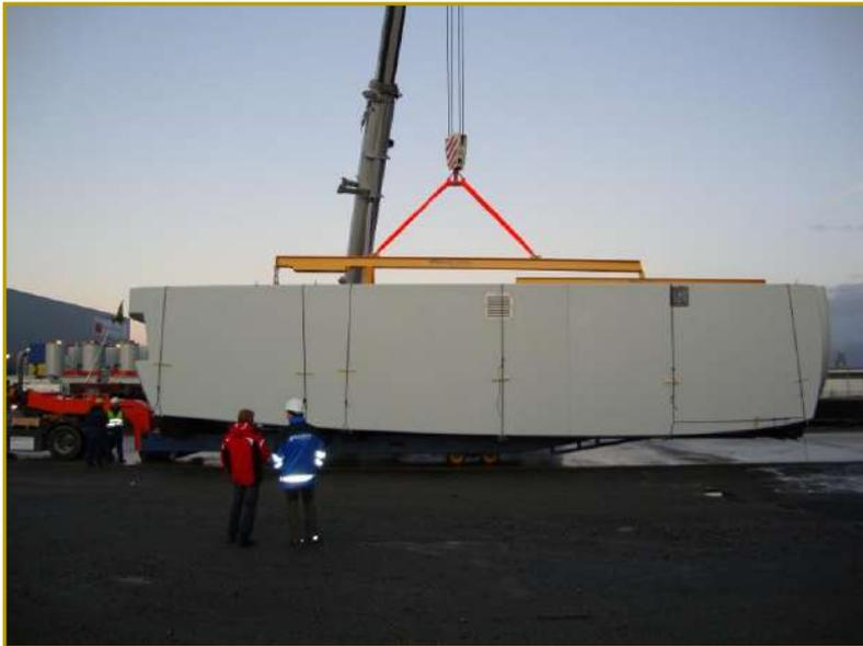
Traversensystem Gondelverkleidung 6 MW
