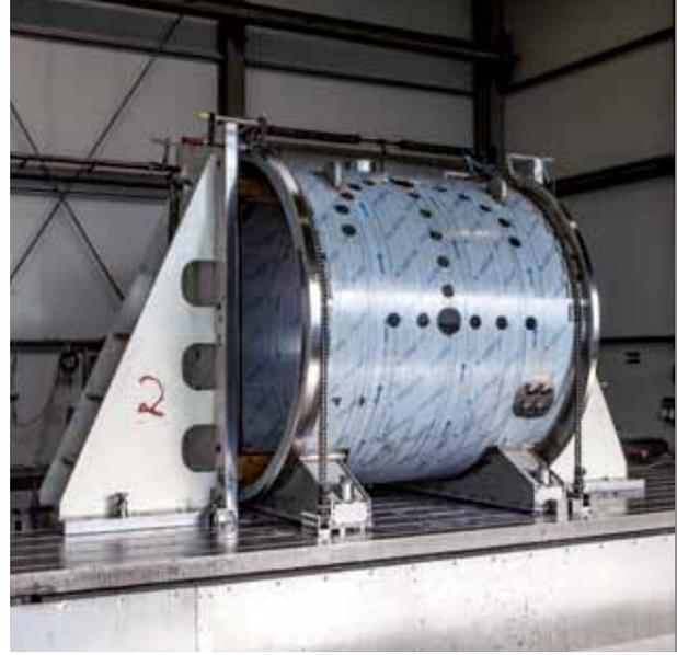
Flansch- u. Mantelbearbeitung Vakuumkammer
