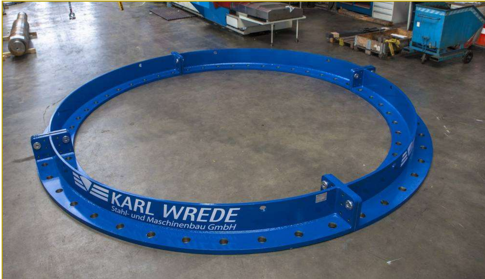
Anchor cage template 3 MW
