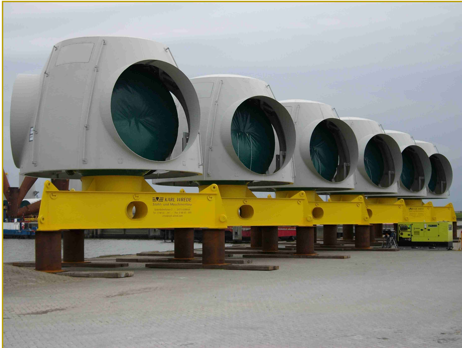
Transportrahmen Rotornabe 5 MW
