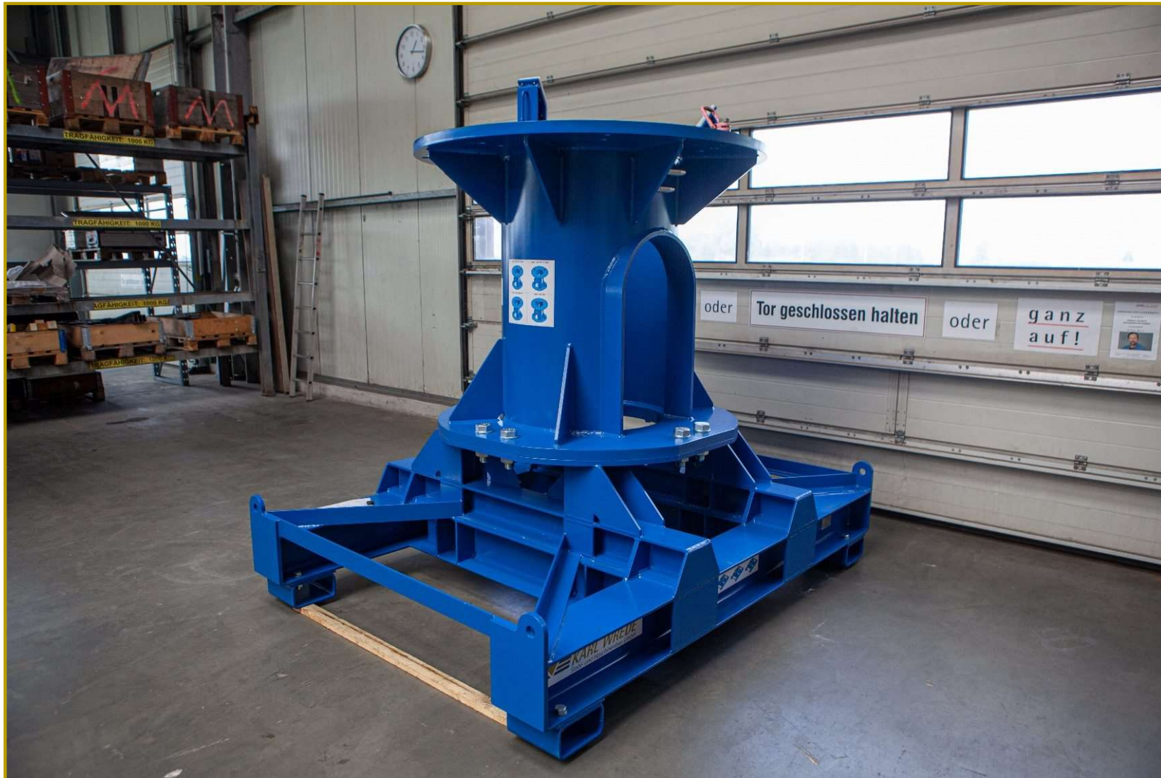
universeller Ablagetisch Rotorstern
