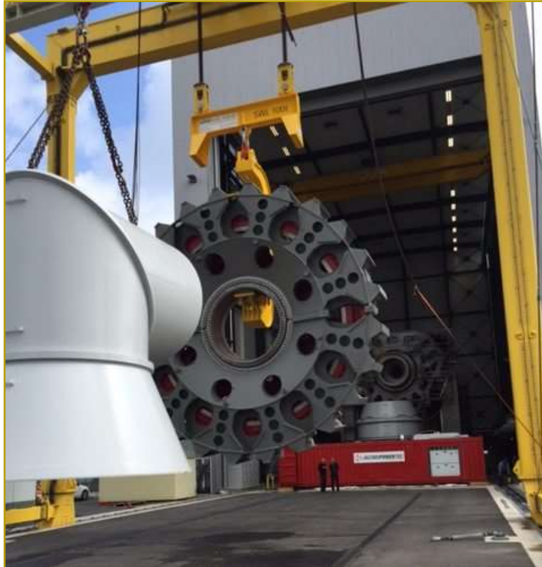
Koppeltraverse Generator 100 t
