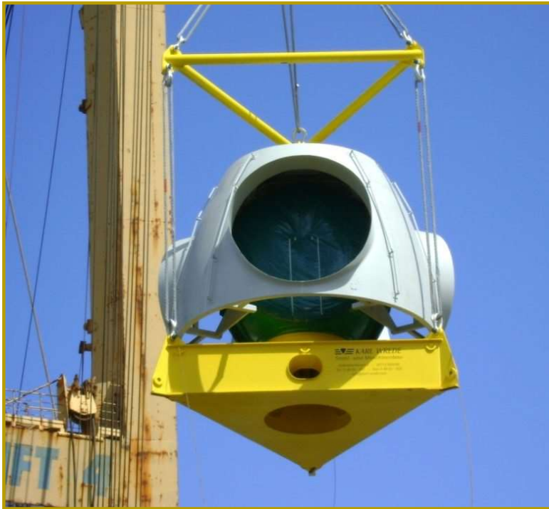
Transportrahmen und Spreize Rotornabe 5 MW
