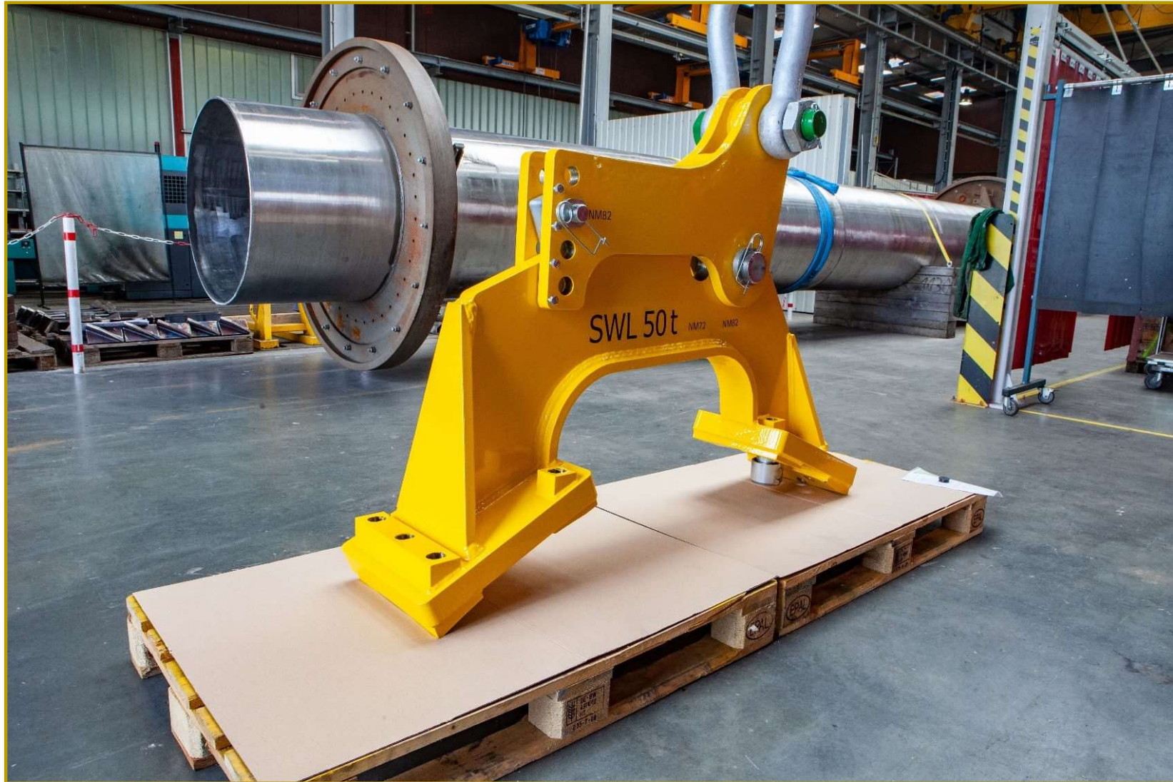
Rotorsterntaverse 2,3 MW – SWL 50 t
