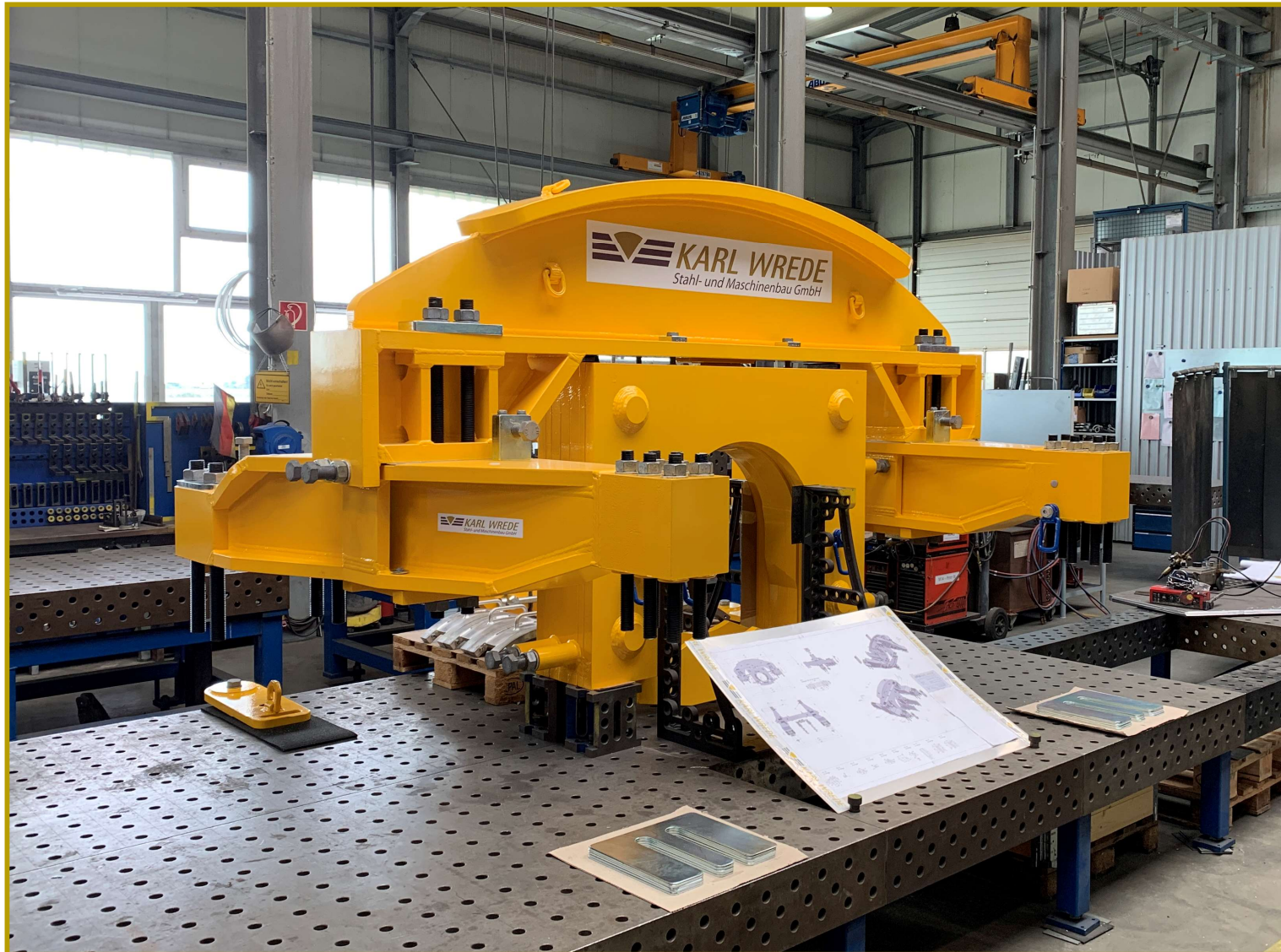
Rotorwellenhalteklammer NORDEX N90
