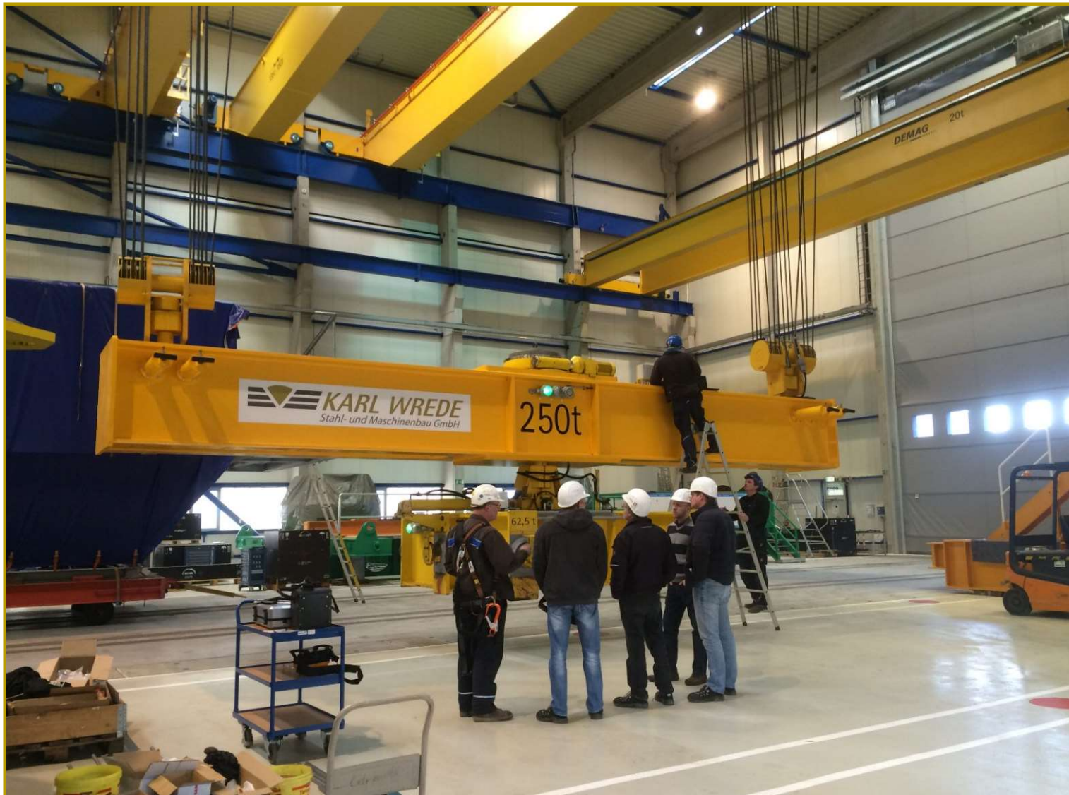
Montagetraverse 250 t mit drehbarer H-Traverse und hydraulischer Schwerpunktverstellung
