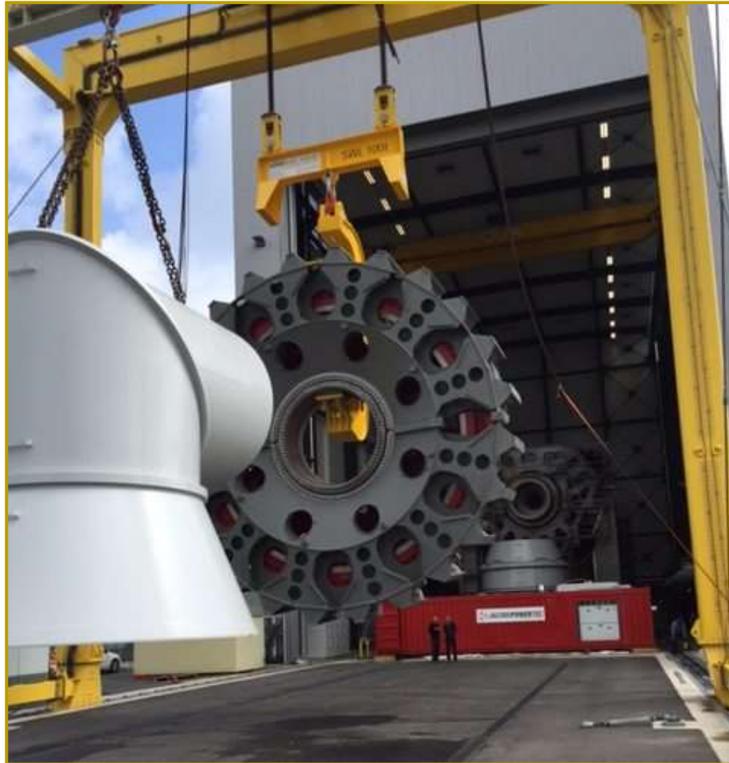
Hebetraverse Rotor 100 t
