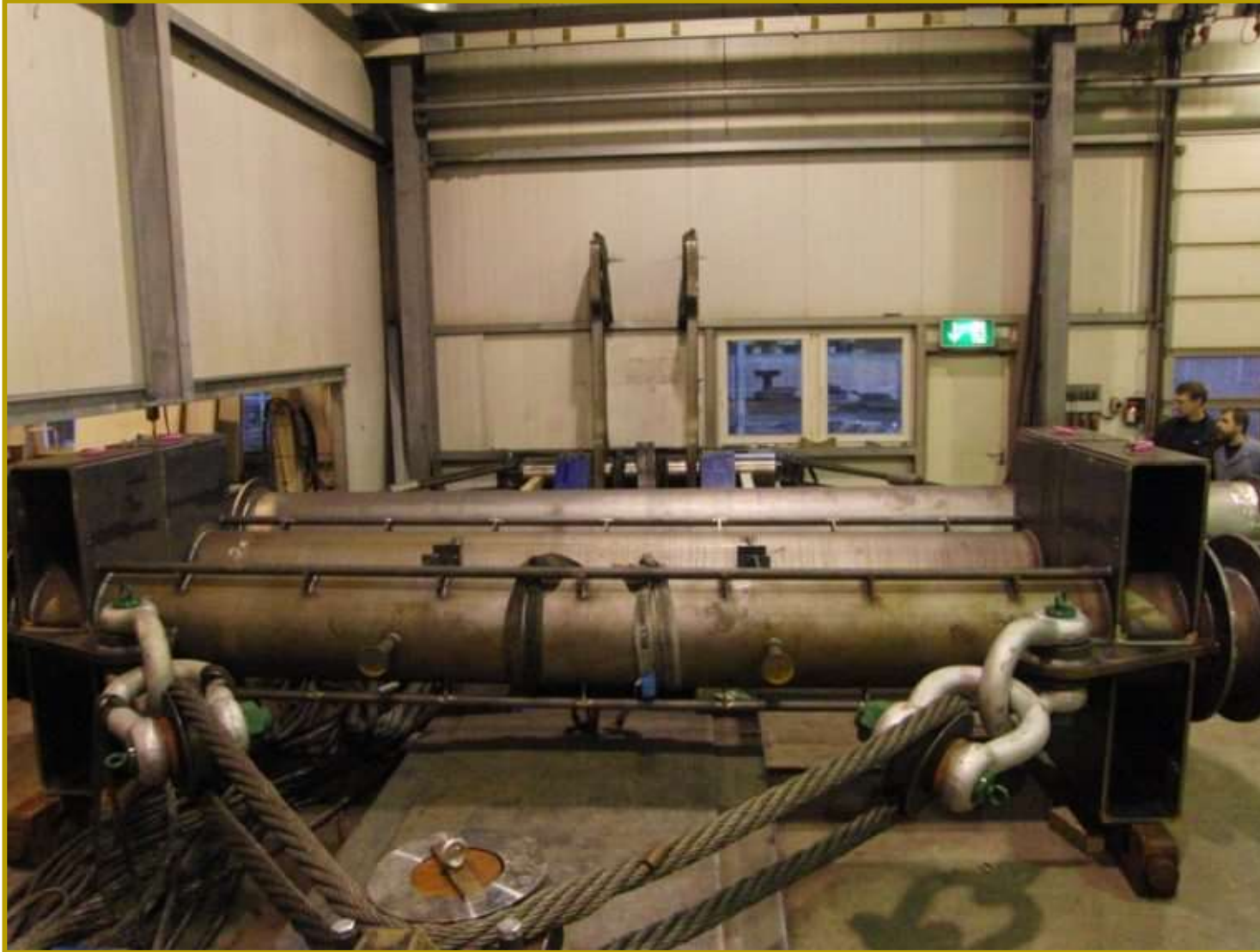
Oberer Hebebalken Turm – SWL 180 t
