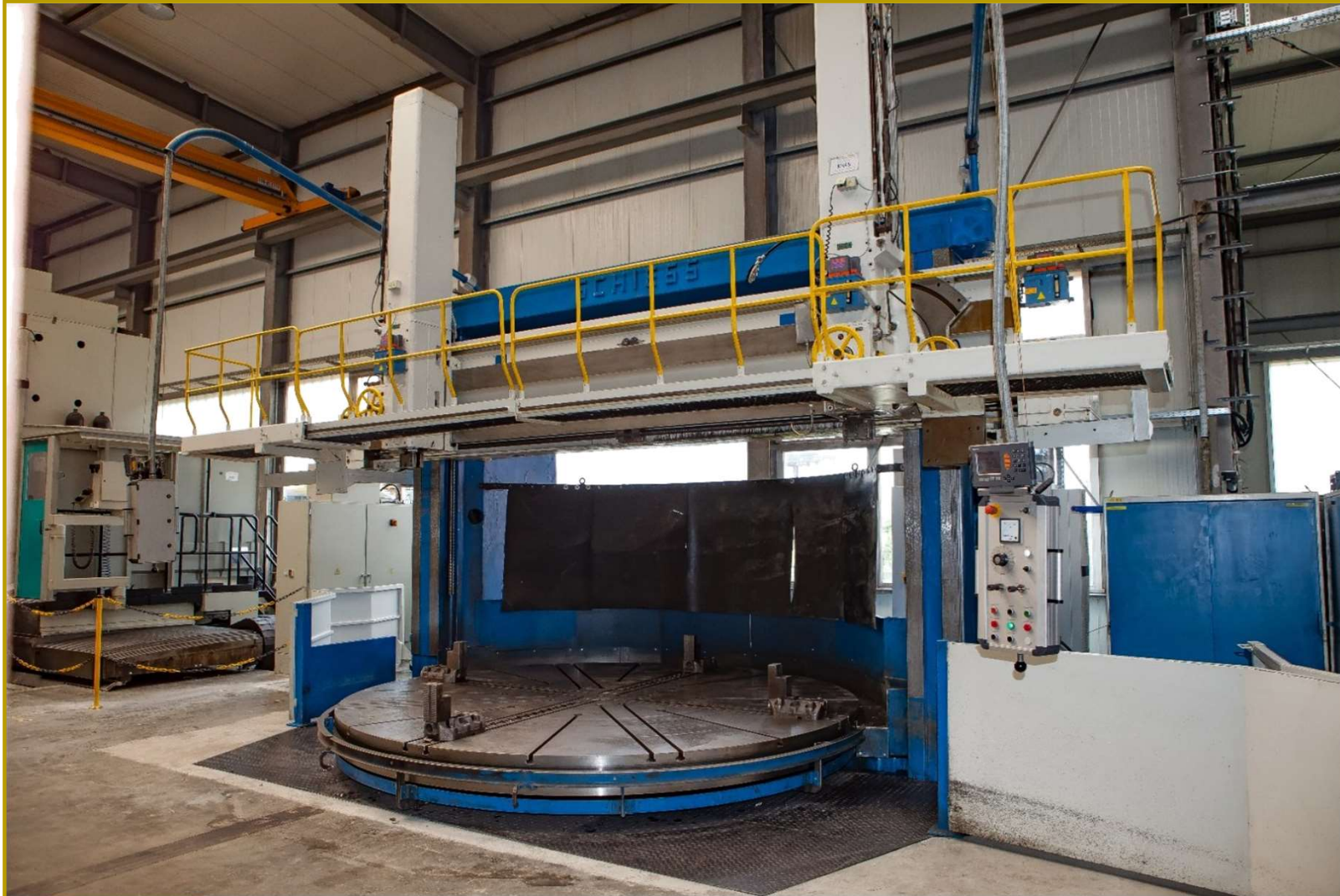
Karusselldrehmaschine Schiess KZ 400-450 bis Drehdurchmesser 4.500 mm
