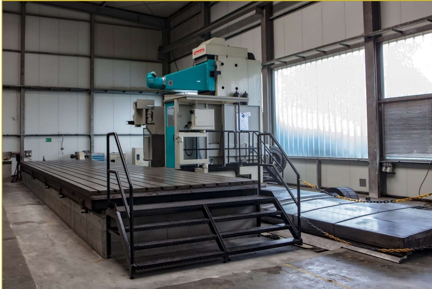
CNC-Fahrständerfräsmaschine Anayak HVM 12000 x/y/z: 11.300/2.000/2.400 – 25 t Stückgewicht
