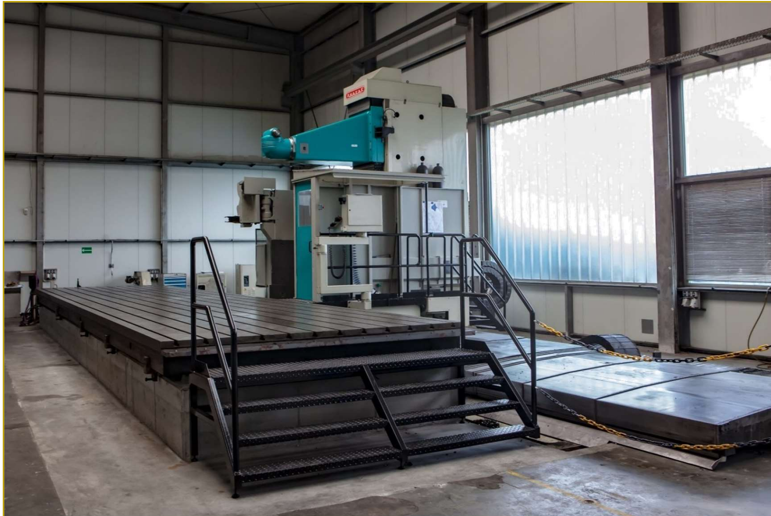
CNC-Fahrständerfräsmaschine Anayak HVM 12000 x/y/z: 11.300/2.000/2.400 – 25 t Stückgewicht
