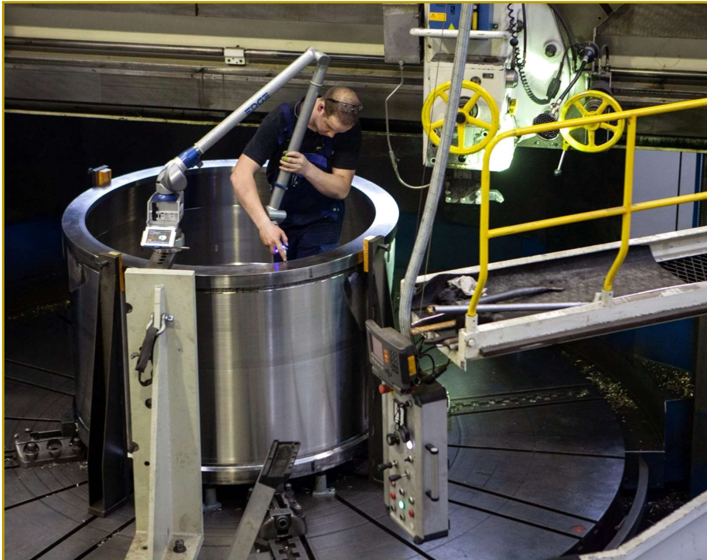
Maßkontrolle mit FARO-Meßarm
