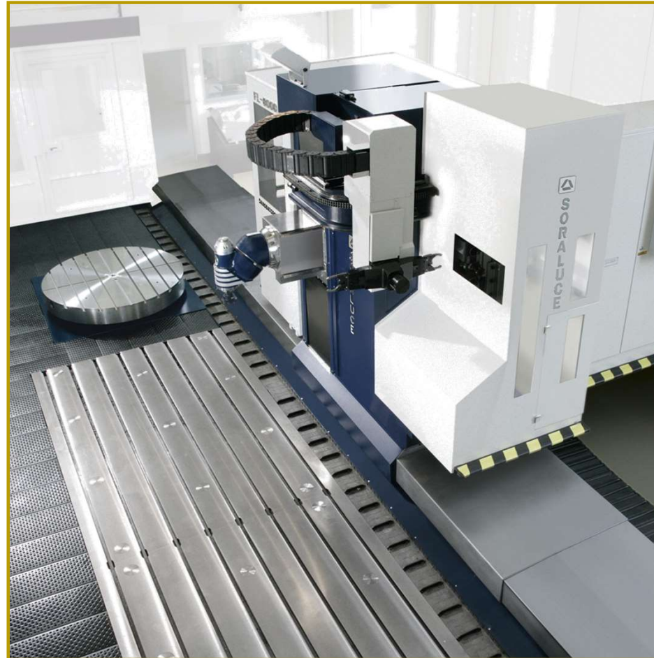
CNC-Fahrständer-Fräsmaschine mit Karusselldrehfunktion SORALUCE FL 5000 x/y/z: 5.000/2.200/1.300 mm, 0.001° frei indexierender Fräskopf Drehtisch 1.750 x 1.750 mm mit 250 min -1 , max. Tischbelastung: 8.000 kg
