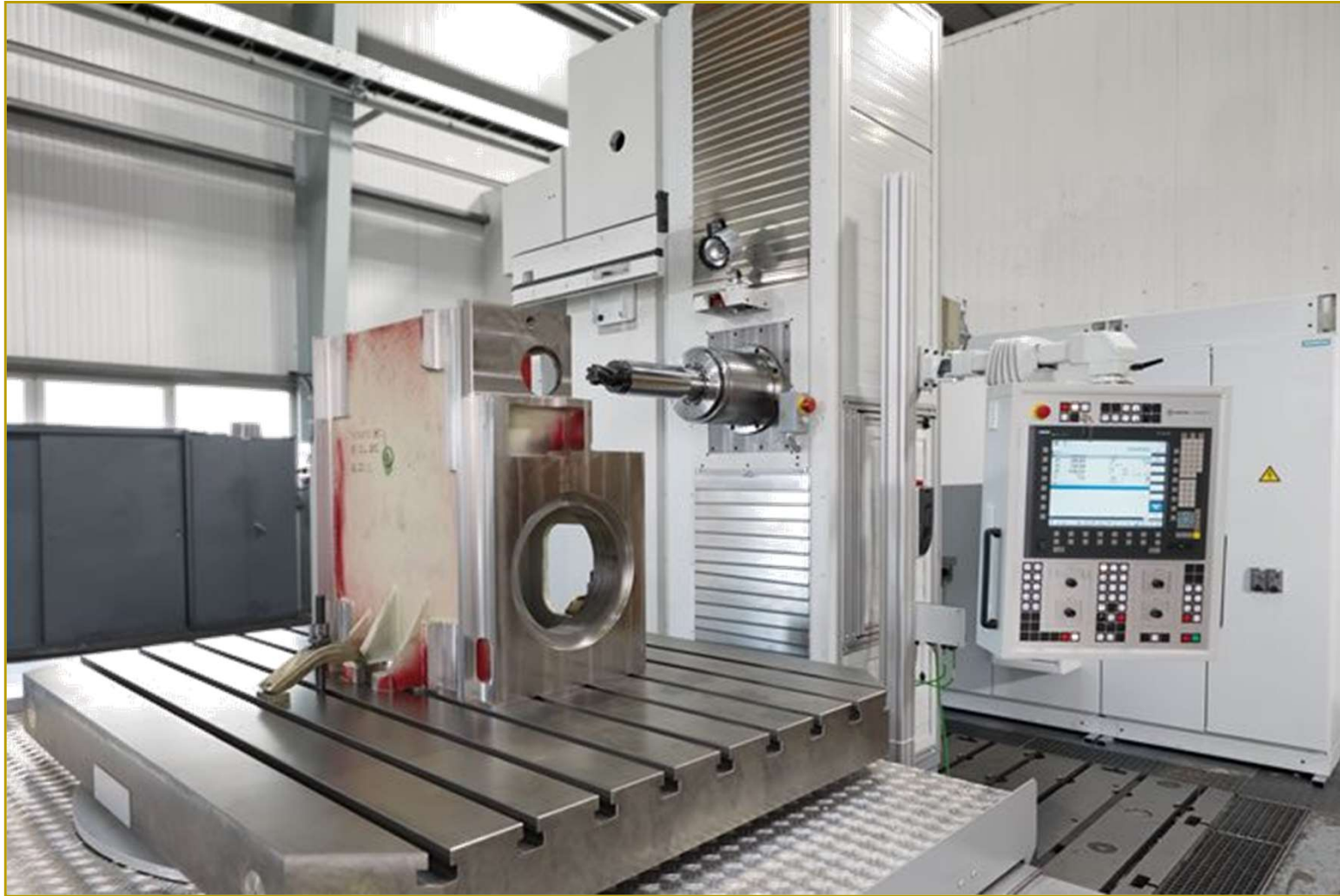
CNC-Tischbohrwerk UNION TC 110 mit Palettenwechsler x/y/z/w: 1.500/2.000/1.600/550 mm, max.Tischbelastung 4.000 kg
