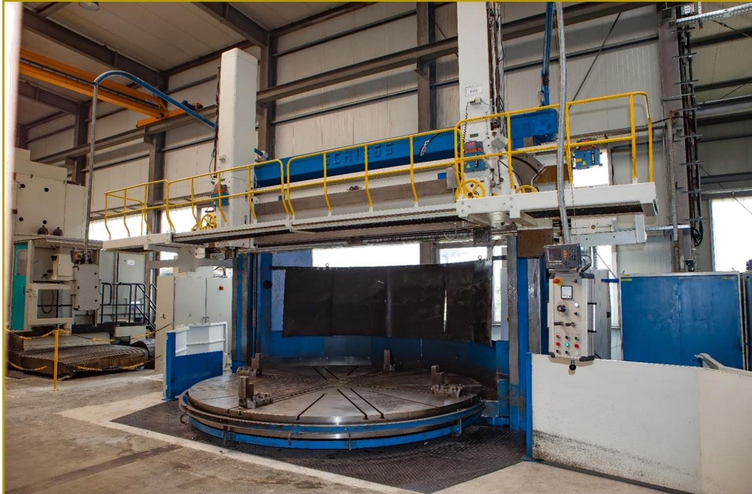
**Karusselldrehmaschine Schuess KZ 400-450 bis Drehdurchmesser 4.500 mm**
