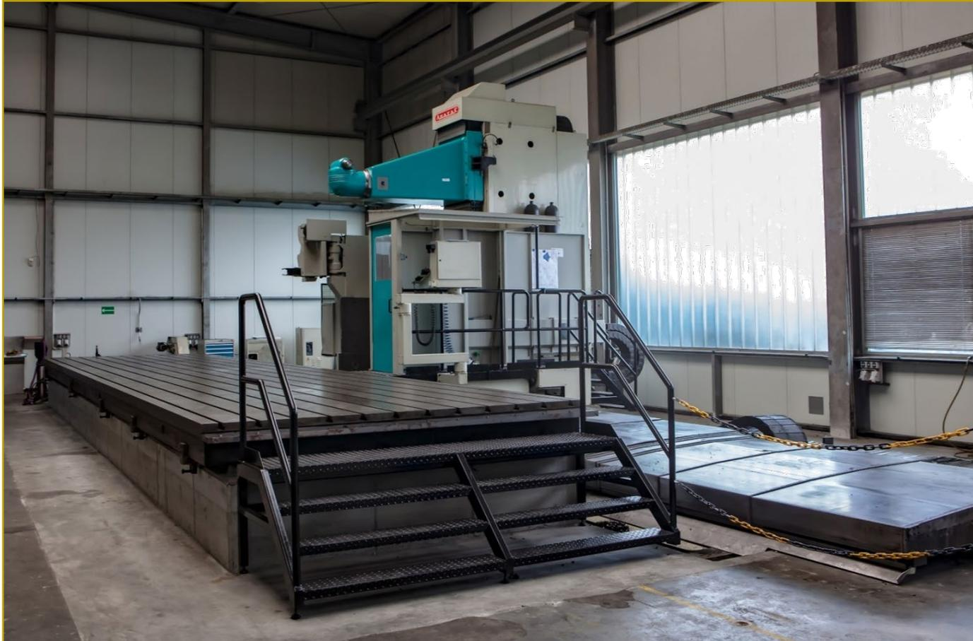
**CNC-Fahrständerfräsmaschine Anayak HVM 12000**
