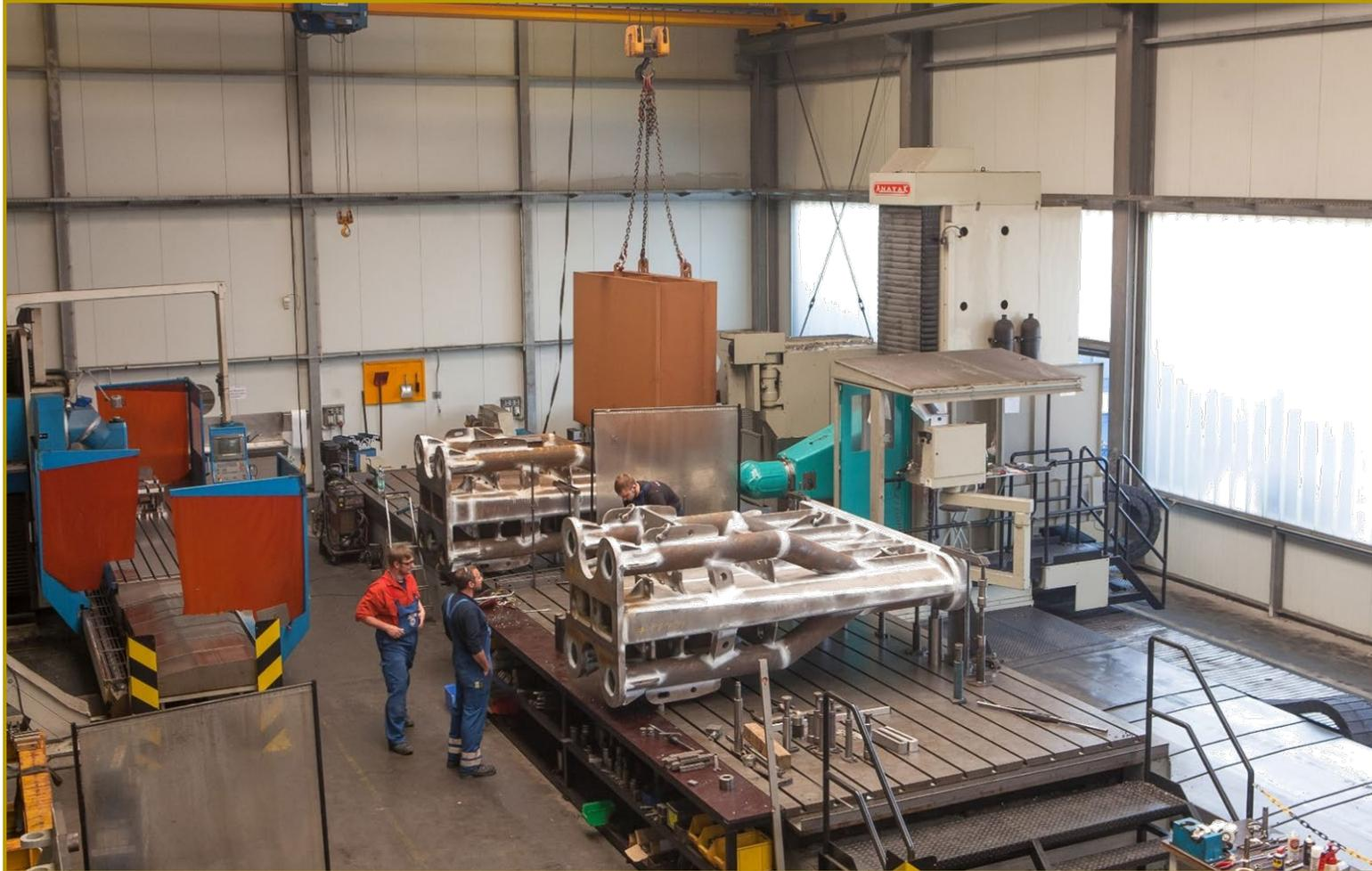
**CNC-Fahrständerfräsmaschine Anayak HVM 12000**
