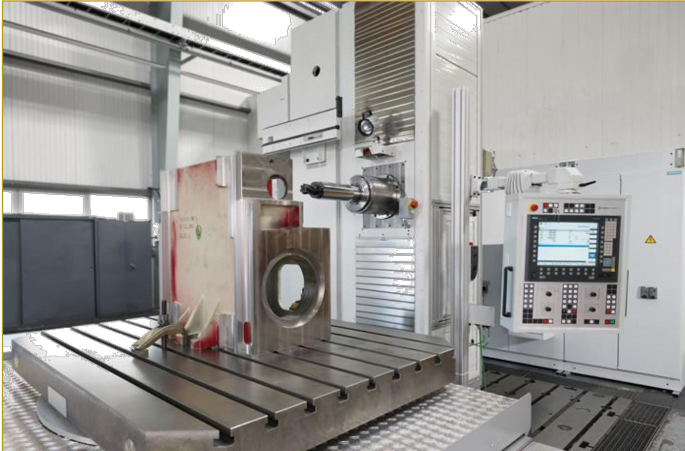
**CNC-Tischbohrwerk UNION TC 110 mit Palettenwechsler**
