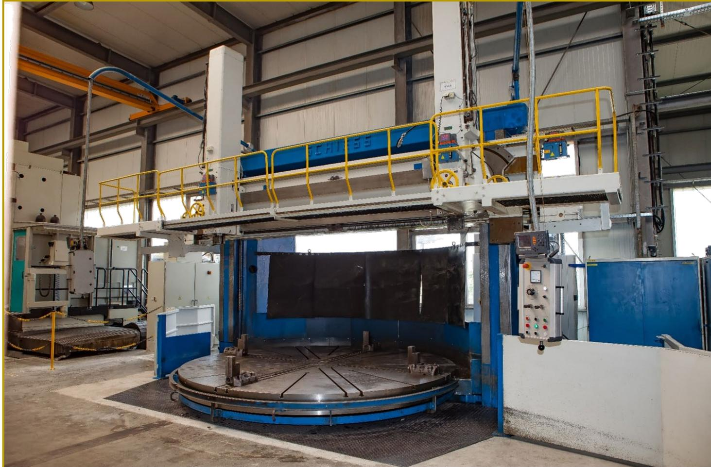
**Karusselldrehmaschine Schiess KZ 400-450 bis Drehdurchmesser 4.500 mm**
