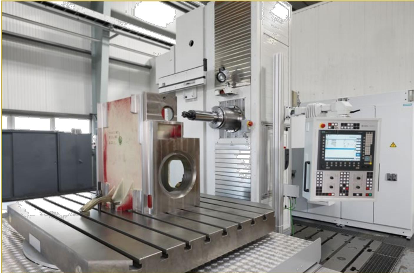
**CNC-Tischbohrwerk UNION TC 110 mit Palettenwechsler**
