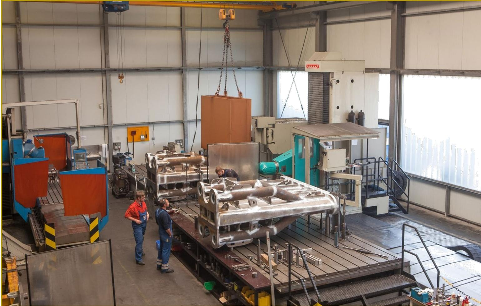
**CNC-Fahrständerfräsmaschine Anayak HVM 12000**
