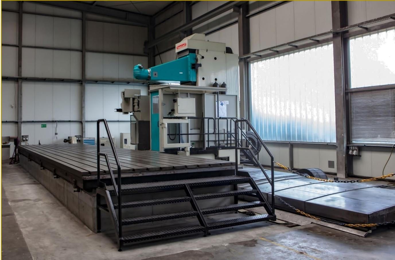
**CNC-Fahrständerfräsmaschine Anayak HVM 12000**
