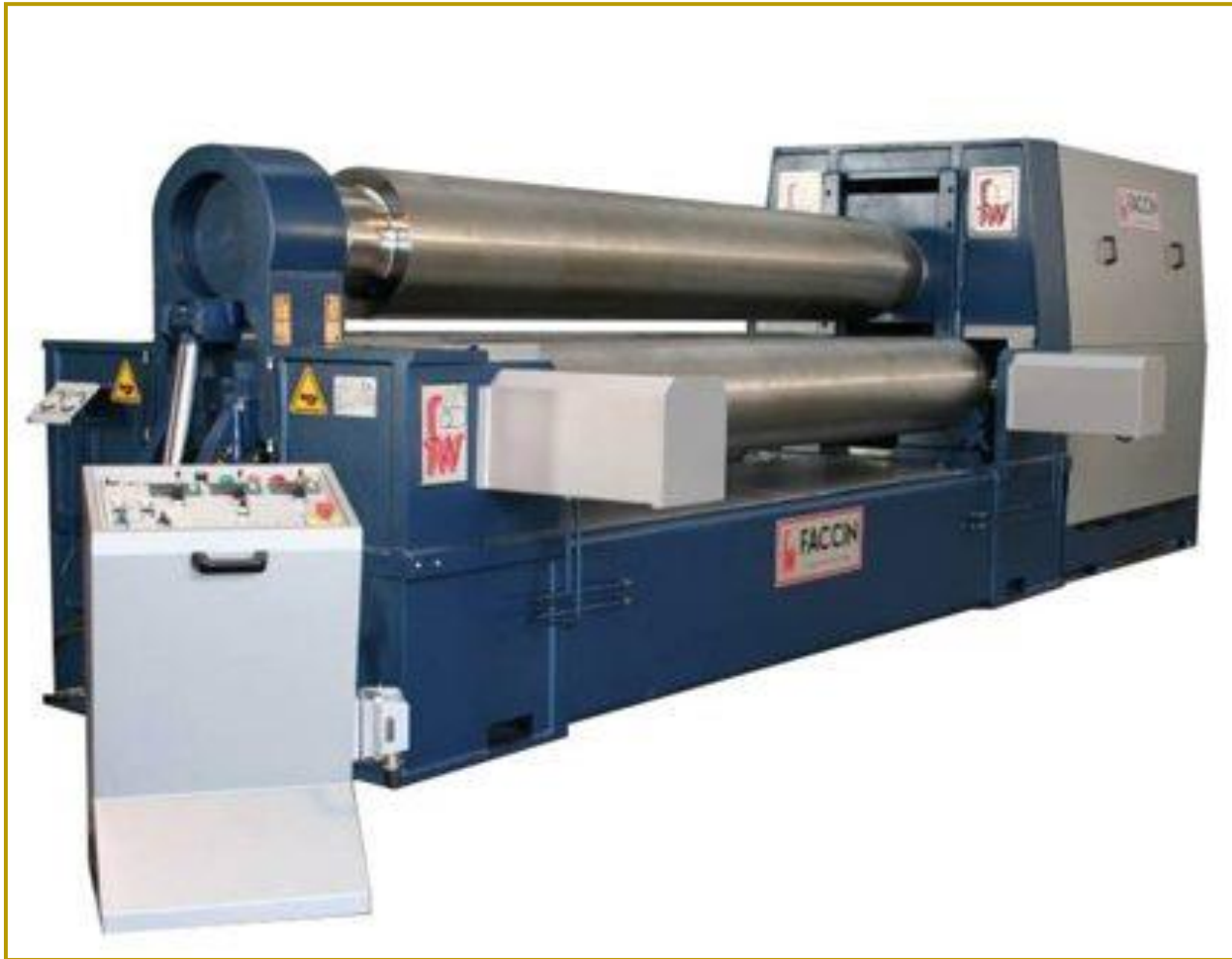
3-Walzen-Rundbiegemaschine FACCIN HAV 3145
