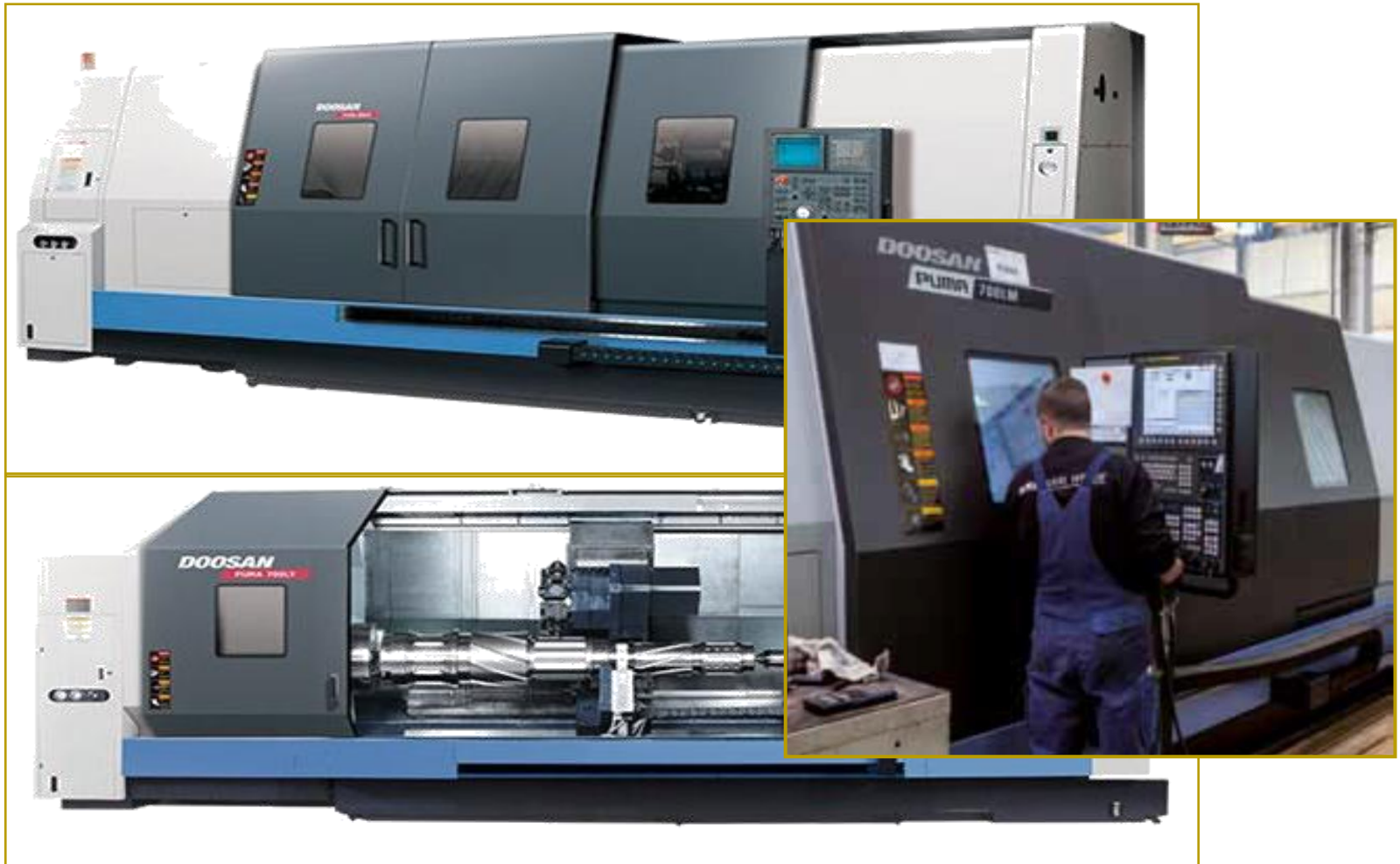
CNC-Drehzentrum DOOSAN PUMA 700 max. Dreh- \varnothing 900 mm x 3.000 mm Drehlänge
