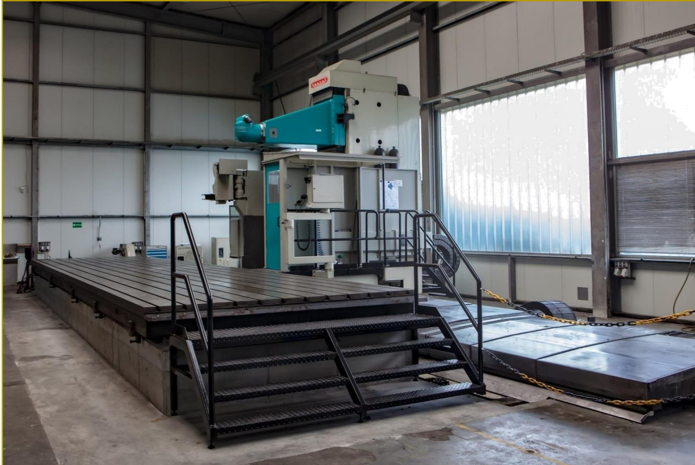
CNC-Fahrständerfräsmaschine Anayak HVM 12000 x/y/z: 11.300/2.000/2.400 – 25 t Stückgewicht
