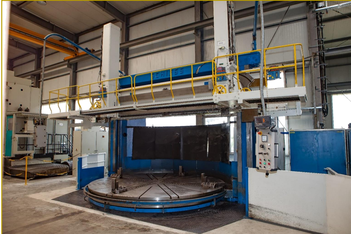
Karusselldrehmaschine Schiess KZ 400-450 bis Drehdurchmesser 4.500 mm
