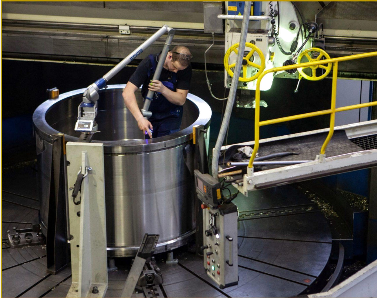
Maßkontrolle mit FARO-Meßarm
