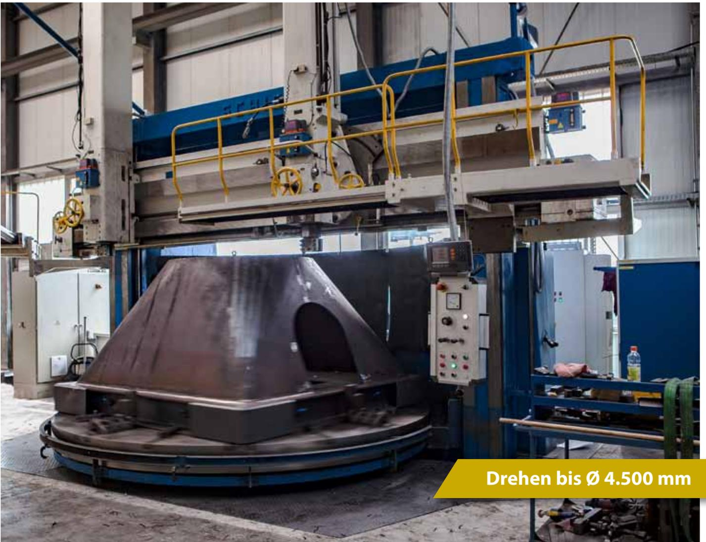
Drehen bis  $\varnothing$  4.500 mm
