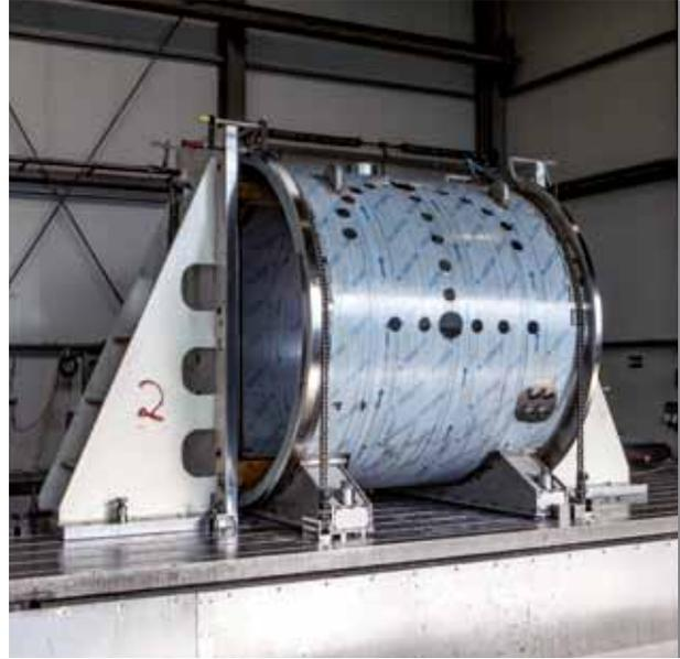
Flansch- und Mantelbearbeitung Vakuumkammer
