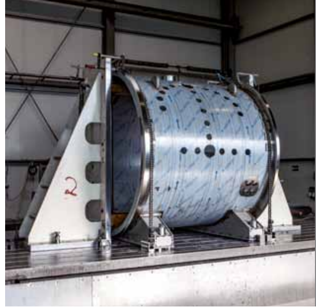
Flansch- u. Mantelbearbeitung Vakuumkammer
