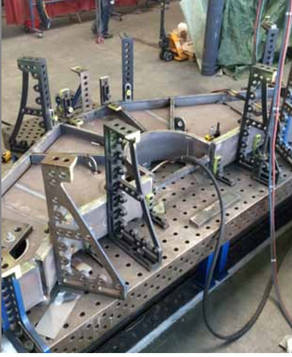
Vorrichten auf 3D-Systemschweißstisch
