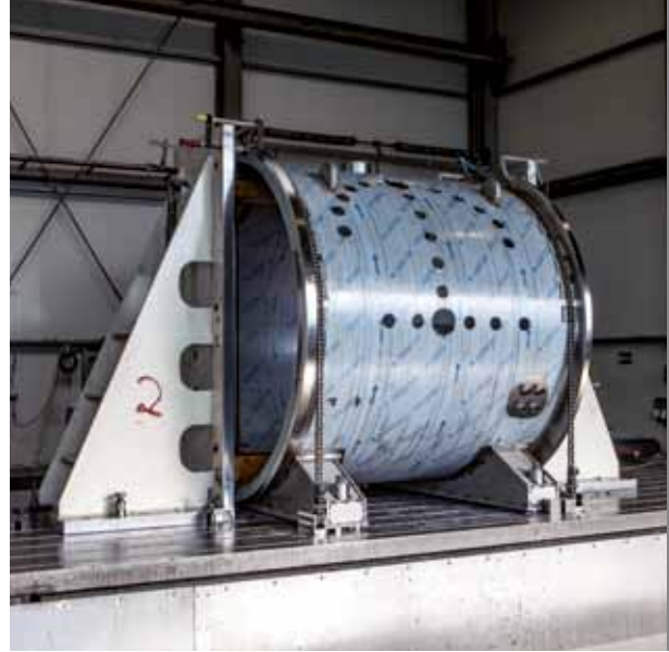
Flansch- und Mantelbearbeitung Vakuumkammer
