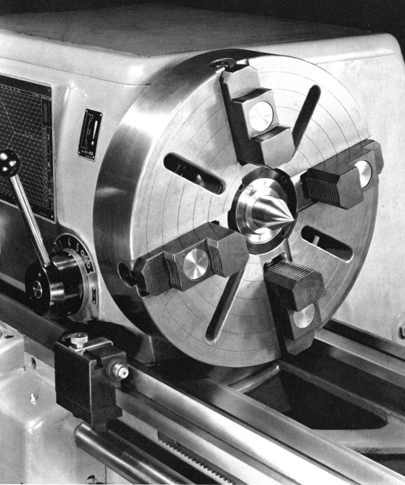
In Deutschland erfreut sich die deutsche Planscheibe mit den schnell umkehrbaren Spannklo- ben nach wie vor großer Beliebtheit. Wir sind jedoch jederzeit in der Lage, den S-Typ, wenn dies so gewünscht wird, auch mit der sogenannten schwedischen Planscheibe auszurüsten. Das Bild zeigt die deutsche Planscheibe, deren Vorteil es ist, daß man auf ihr die Kloben sehr weit zur Mitte hin verstellen kann.
