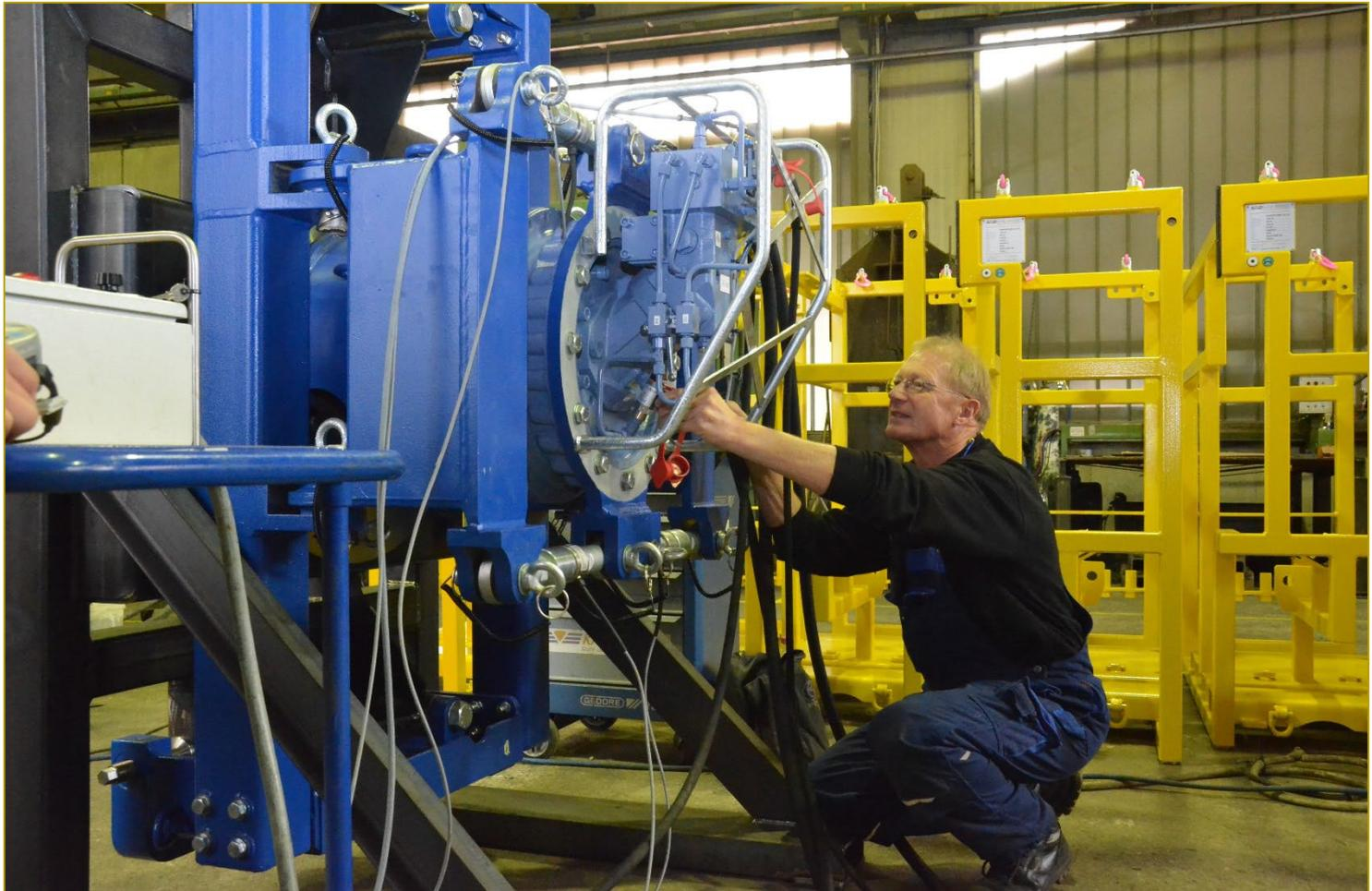
Hydraulisches Drehantriebssystem Triebstrang 6 MW offshore (Einzelblattmontage): Testvorrichtung
