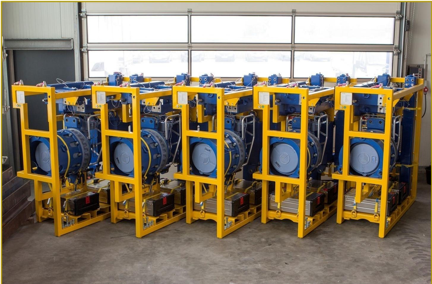
Hydraulisches Drehantriebssystem Triebstrang 6 MW offshore (Einzelblattmontage): Auslieferung
