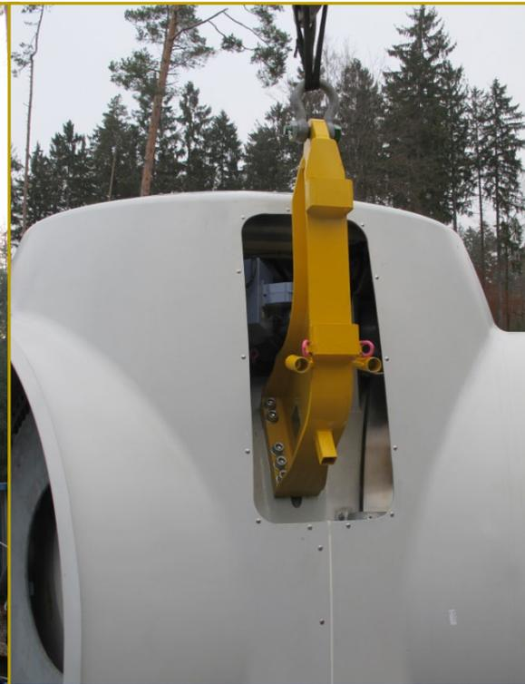
Traversensystem Heben und Drehen Nabe 3 MW
