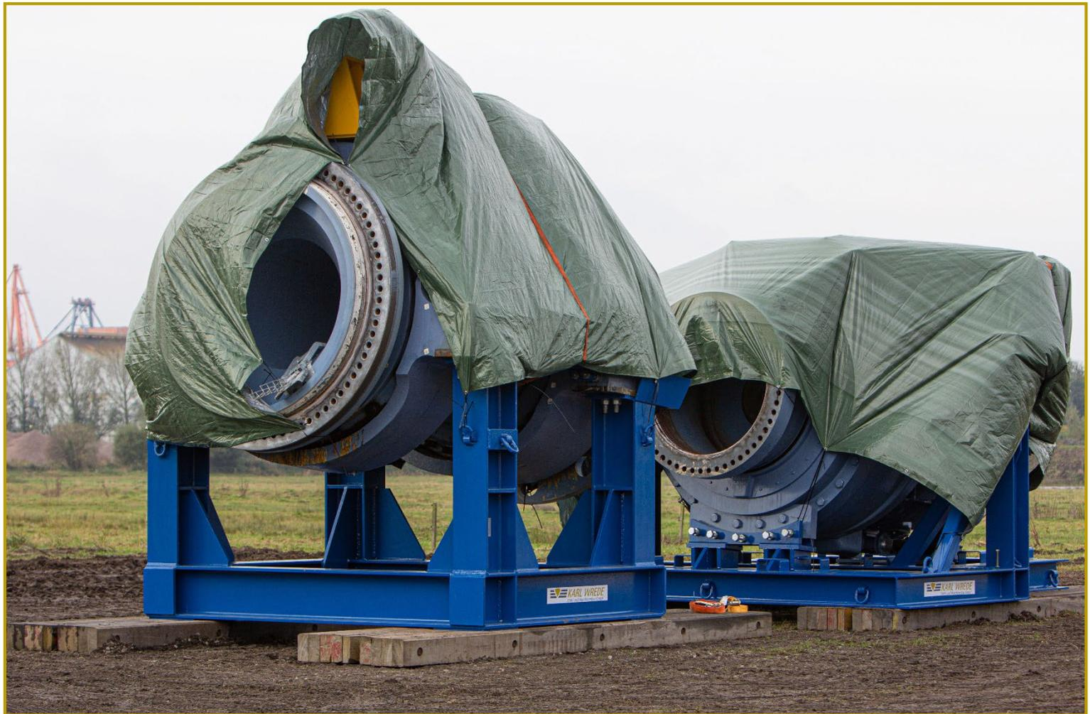
Offshore-Transportgestell Rotortwellenbaugruppe und Getriebe 5 MW
