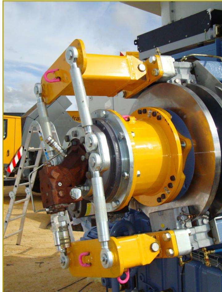
Hydraulisches Drehantriebssystem Triebstrang 3 MW (Einzelblattmontage)
