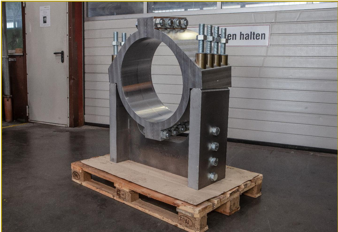
Rotorwellenhalteklammer Siemens 2,3 MW
