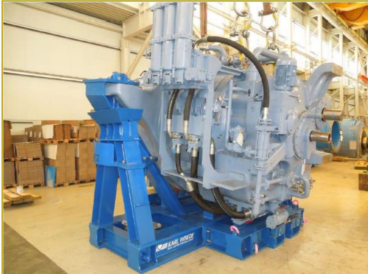
Offshore-Transportgestell Getriebe 6 MW
