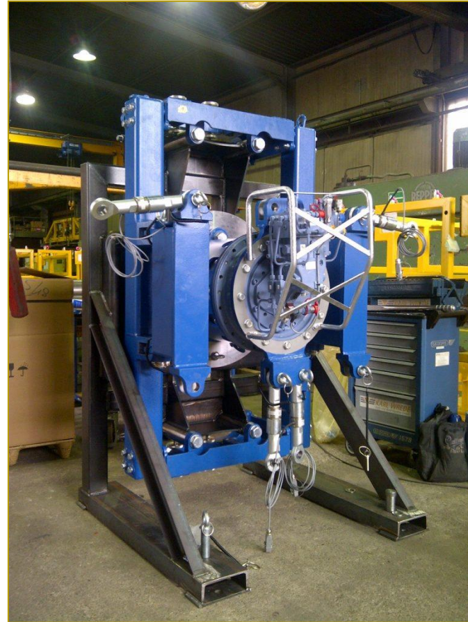
Hydraulisches Drehantriebssystem Triebstrang 6 MW offshore (Einzelblattmontage): Testvorrichtung
