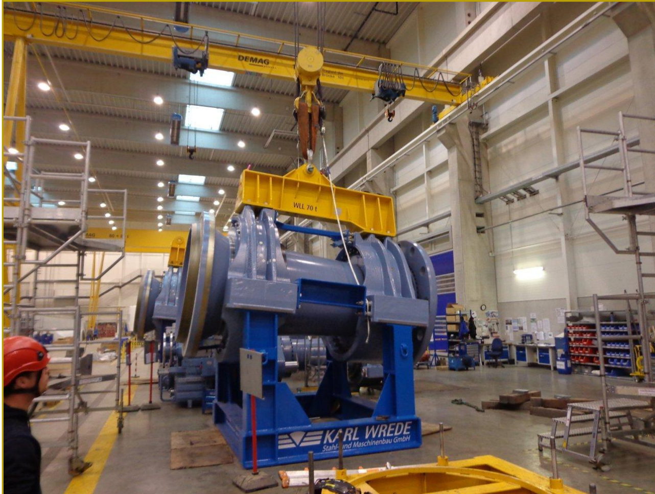
Rotorwellenbaugruppen-Transportrahmen und Traverse 5/6 MW
