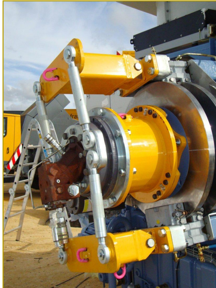
Hydraulisches Drehantriebssystem Triebstrang 3 MW (Einzelblattmontage)
