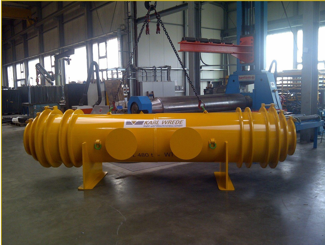
Gondeltraverse SWL 480 t – manuelle Schwerpunktverstellung
