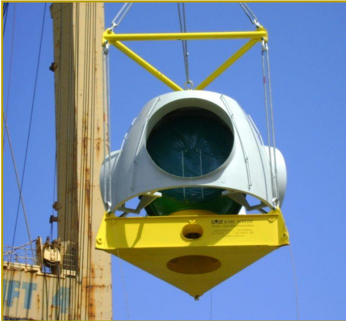
Transportrahmen und Spreize Rotornabe 5 MW
