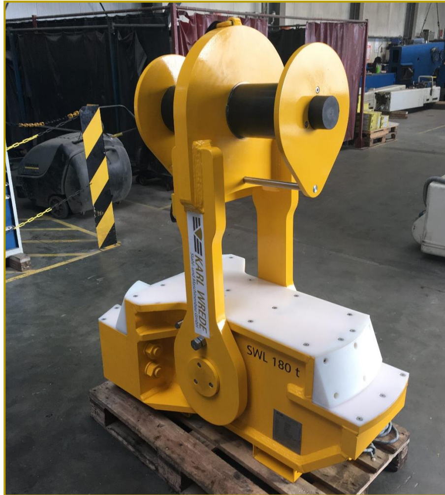
Lastaufnahmemittel Rotorstern SWL 180 t – 6 MW
