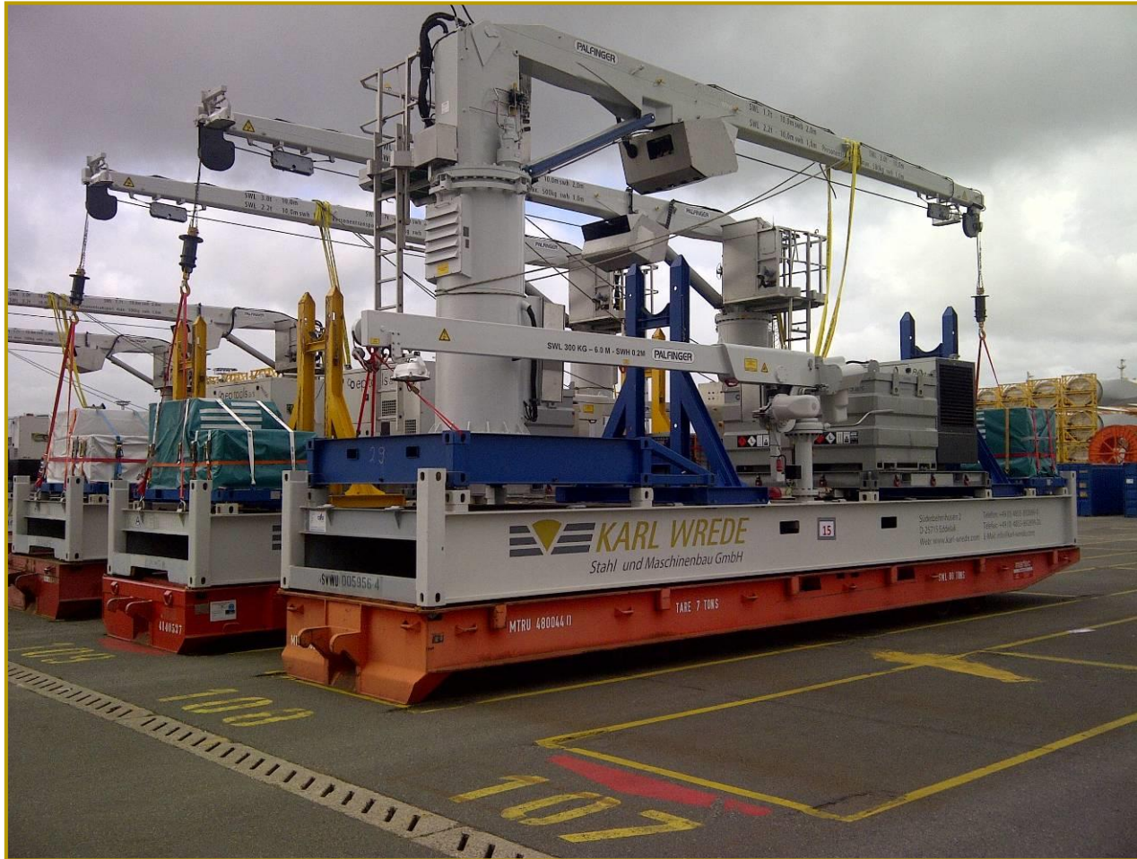
modifizierte 40ft flatracks für Komponententransport
