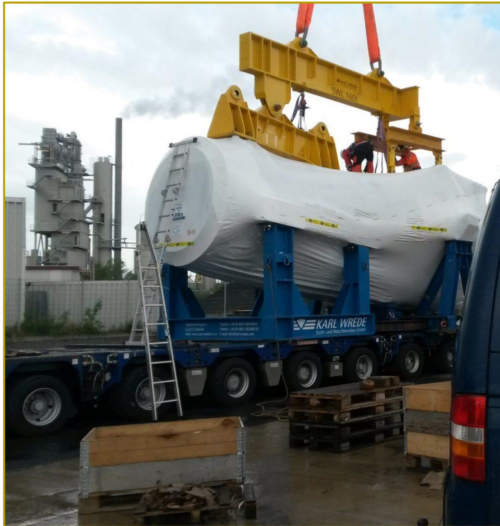
Traversenkombination Triebstrang 6 MW
