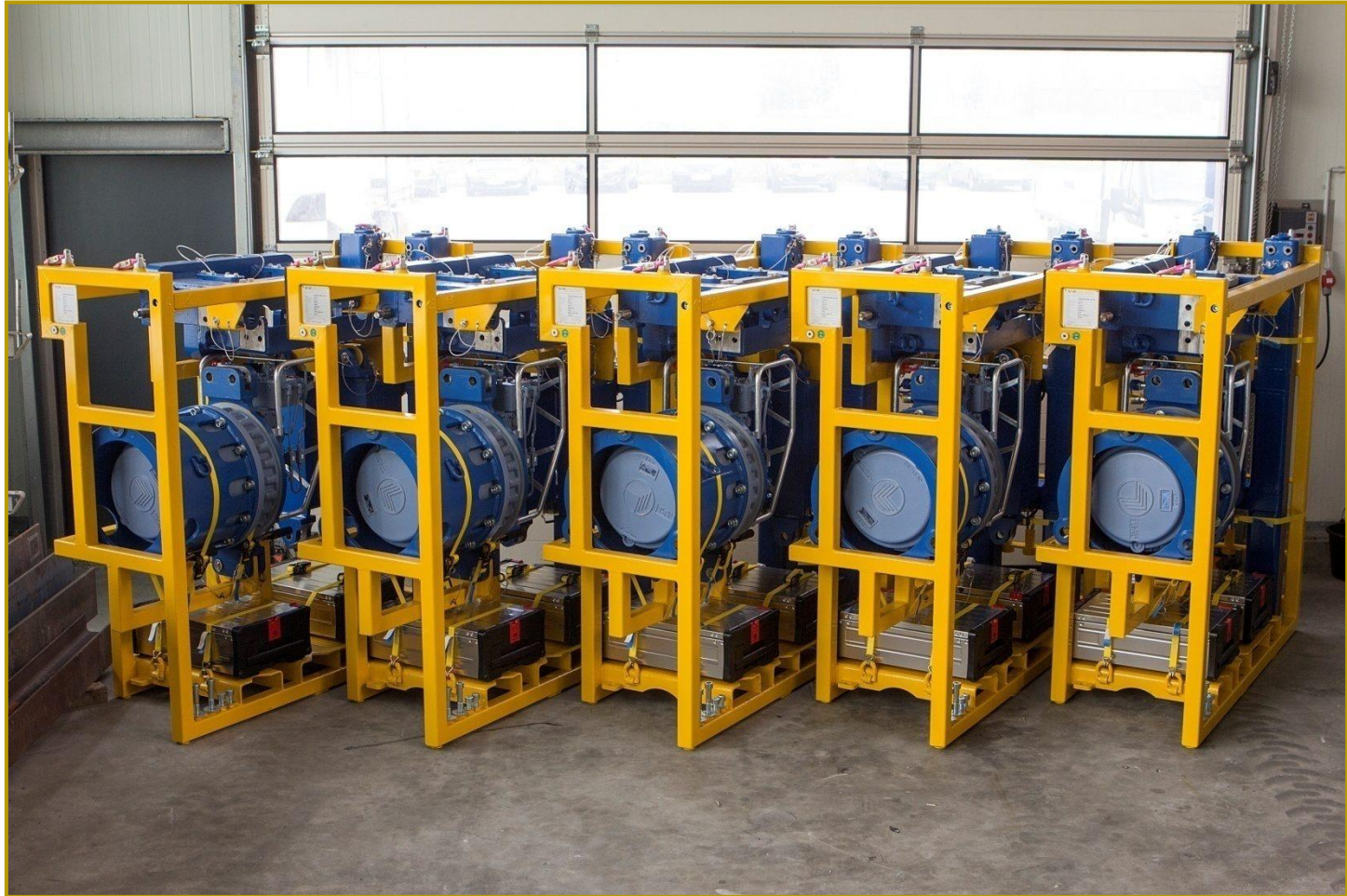
Hydraulisches Drehantriebssystem Triebstrang 6 MW offshore (Einzelblattmontage): Auslieferung
