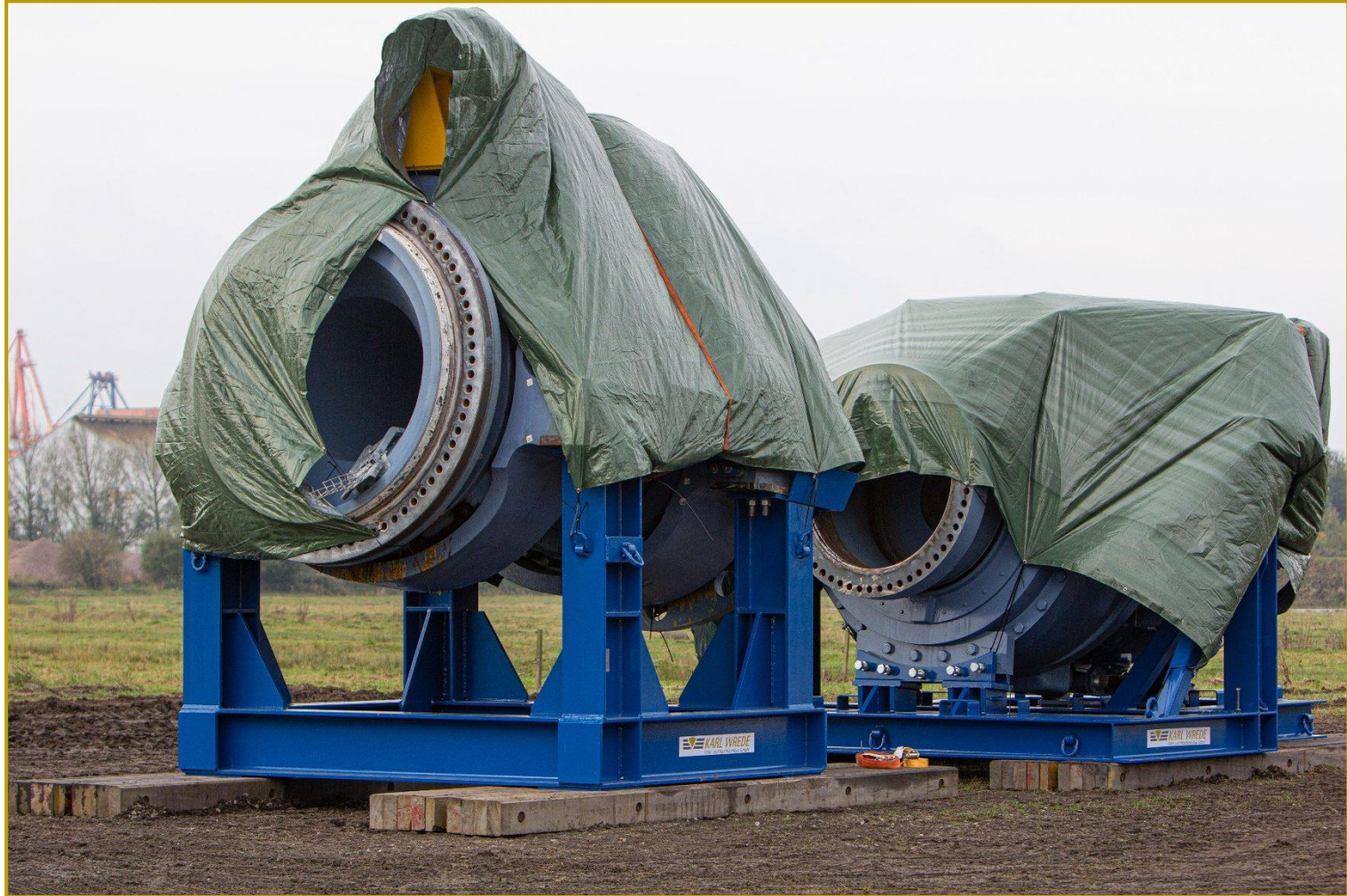
Offshore-Transportgestell Rotortwellenbaugruppe und Getriebe 5 MW
