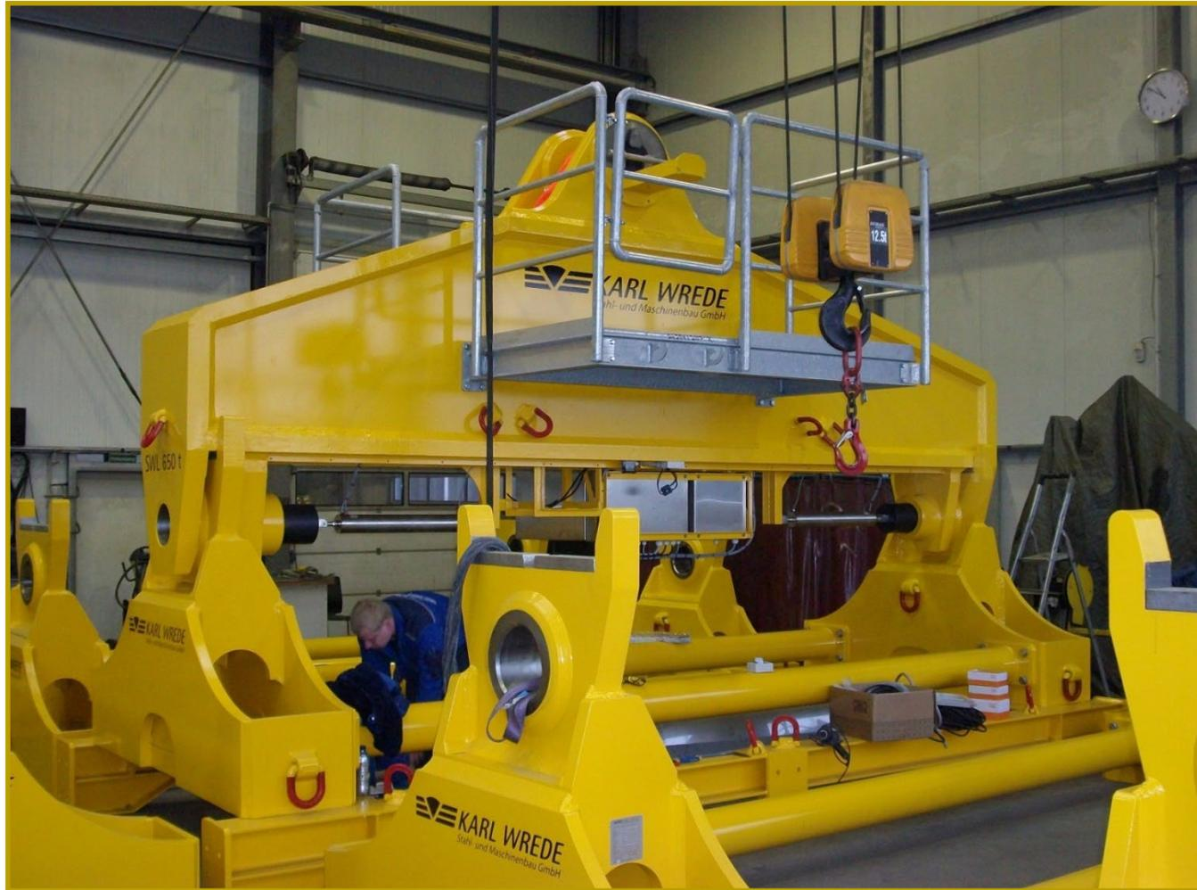
**funkferngesteuerte Installationstraverse SWL 650 t**
