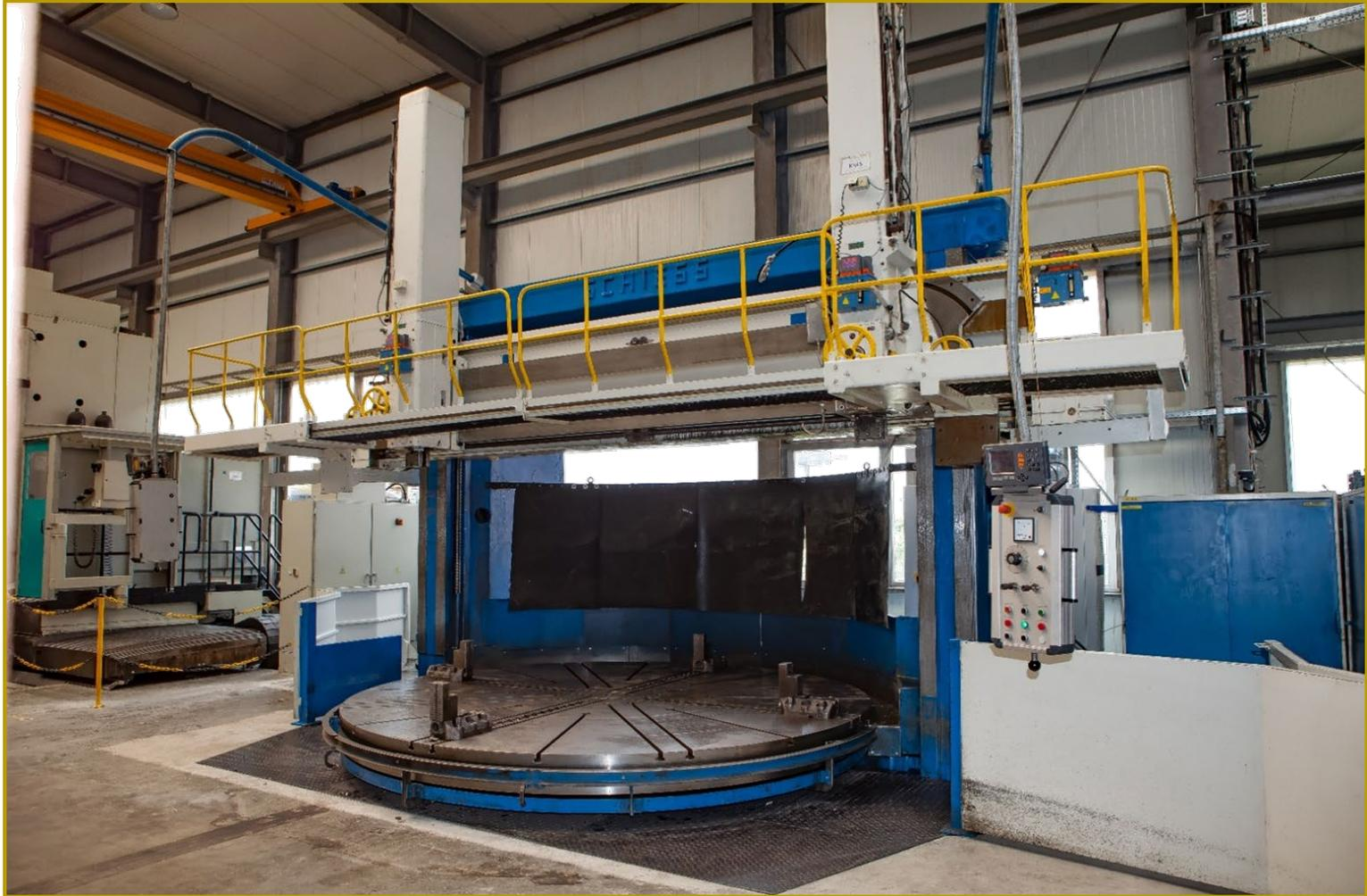
**Karusselldrehmaschine Schless KZ 400-450 bis Drehdurchmesser 4.500 mm**
