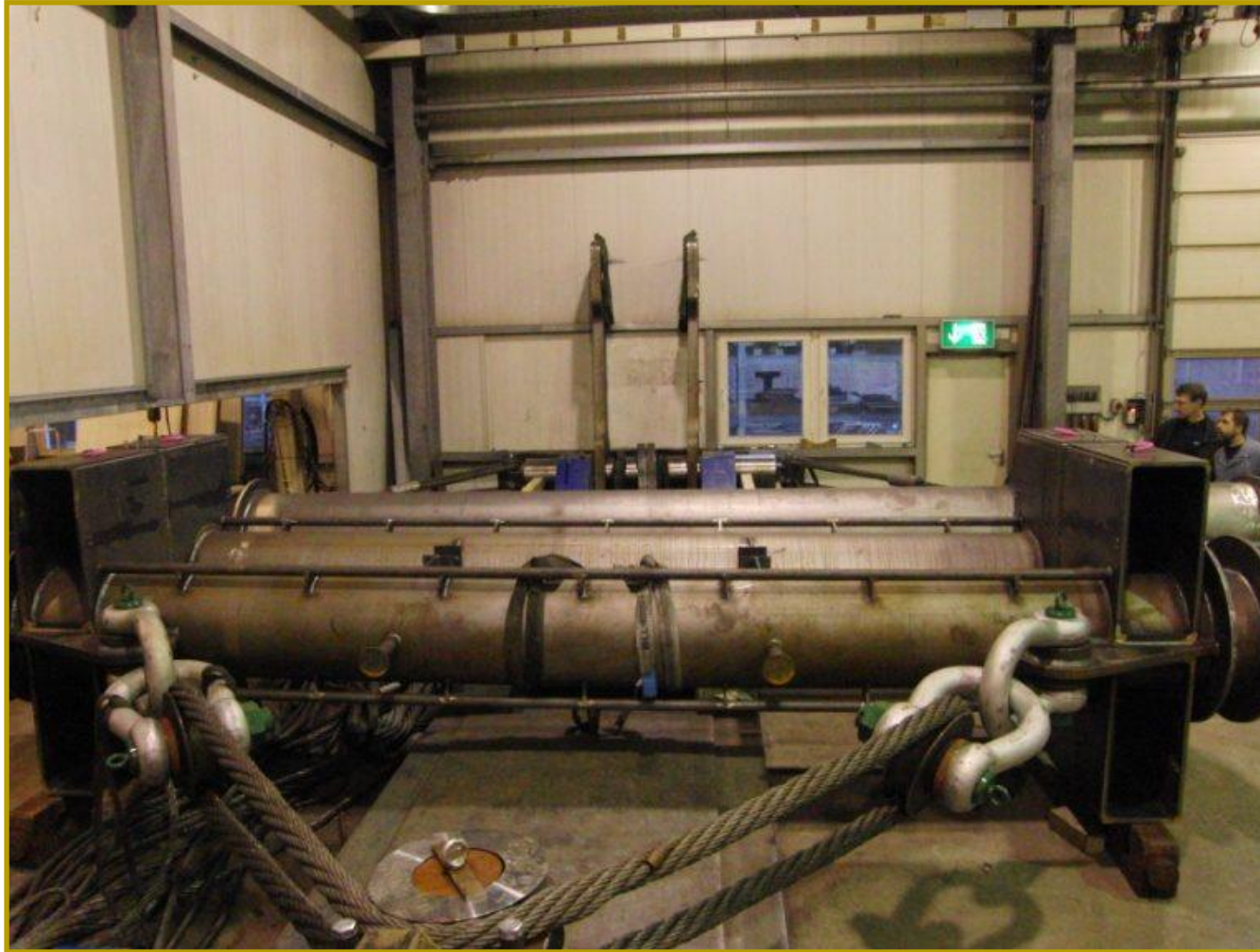
Oberer Hebebalken Turm – SWL 180 t
