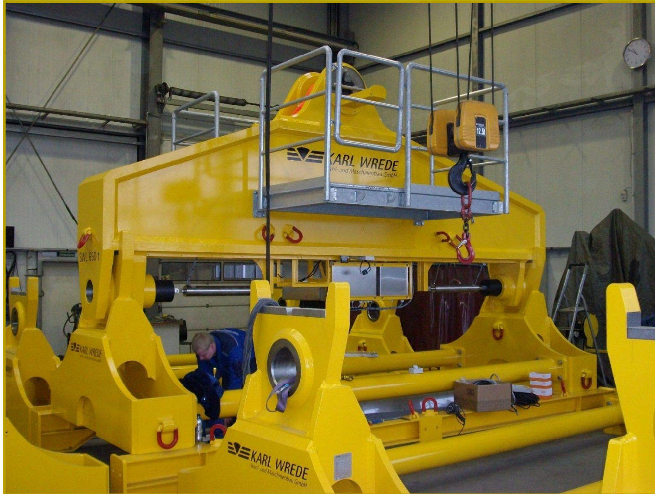
funkferngesteuerte Installationstraverse SWL 650 t
