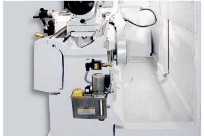
Spänewanne hinter dem Maschinenbett und stabile, längs verschiebbare Spänerückwand
