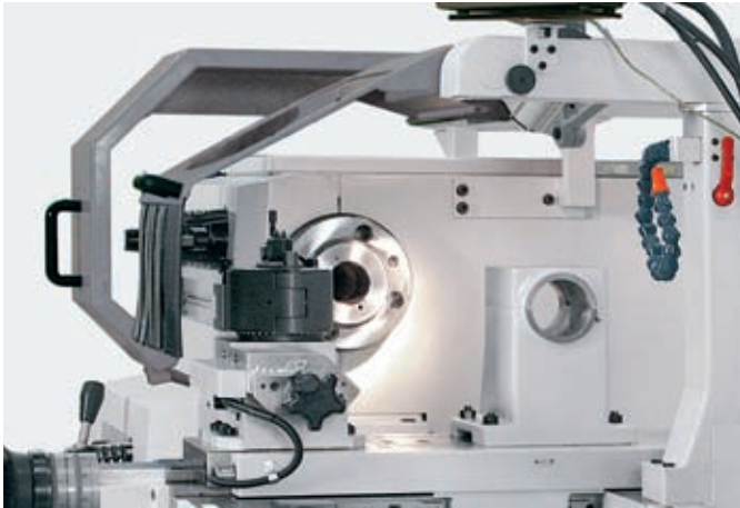
Spannfutterschutz / Späneschutz / Schnellwechsel-Stahlhalter
