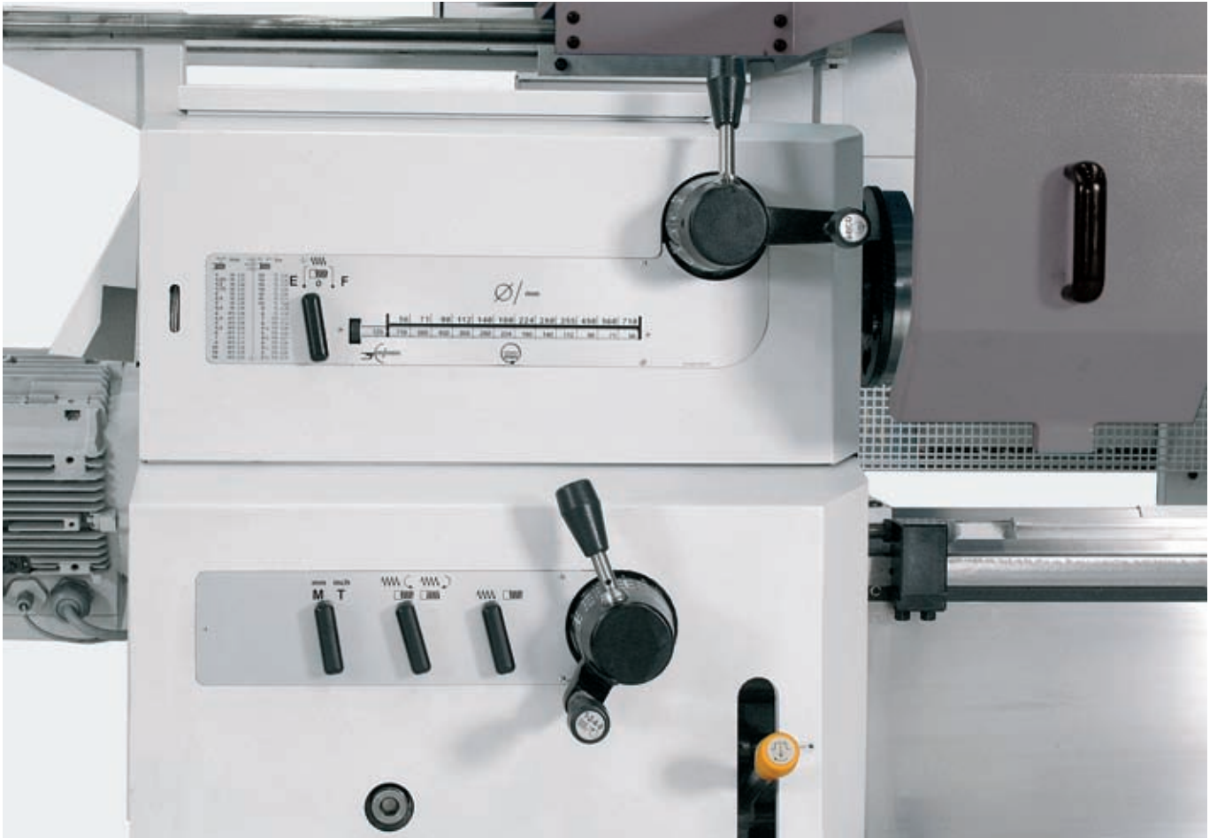
Getriebestufe bzw. Drehzahl und Vorschubwerte sind über Zwei-Hebel-Schaltwerke sicher und schnell einstellbar
