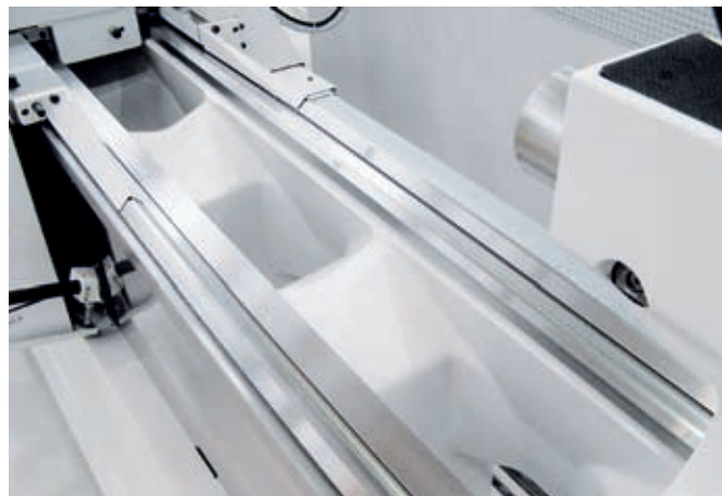
Starres Kastenbett mit schräg nach hinten abfallenden großen Späneschächten
