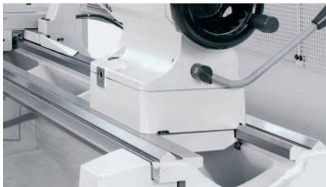
Gehärtete Prismenführungen mit doppelter Prismenführung hinten
