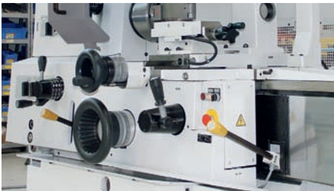
Hauptspindel EIN/AUS und Drehrichtungswchsel mittels Fernschalthebel
